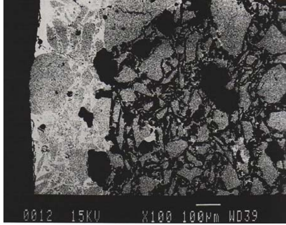
Resim 58. Hanedanlık dönemine ait bir shabtinin, sementasyon ile sırlanmış mısır çamuru yüzeyinin tarayıcı elektron mikroskobuyla detaylandırılmış görüntüsü (BM RL16323); sırlı kısım beyaz, kuvars kısım koyu gri, boş alanlar ise siyah renktedir.
