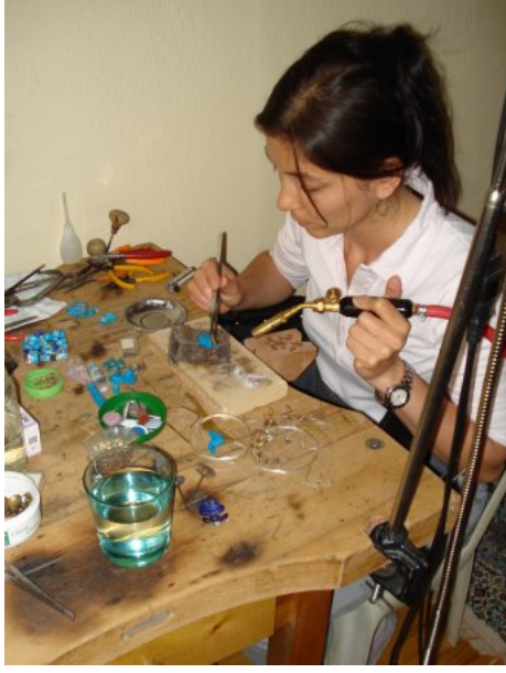
Resim 62. Formun metal bağlantılarının hazırlanıp, kaynak yapılarak birleştirilmesi işlemi.
