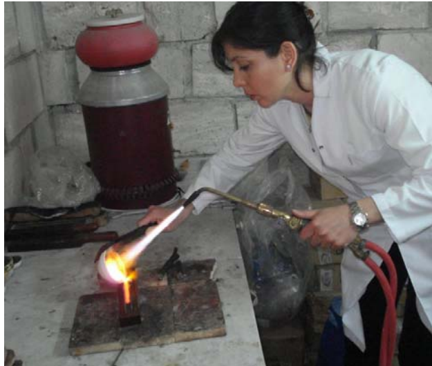
Resim 61. Gümüş'ün eritilerek (950 ve 925 ayara düşürüp), tel ve levha kalıplara dökme işlemleri.
