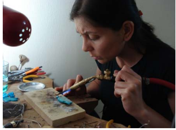
Resim 62. Formun metal bağlantılarının hazırlanıp, kaynak yapılarak birleştirilmesi işlemi.
