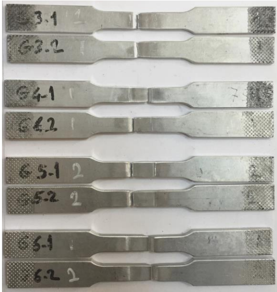
Şekil 13. Çekme deneyi sonunda kırılma yerlerini gösteren örnek numuneler (Her bir levha kalınlığı için ikişer numune örnek olarak verilmiştir).
