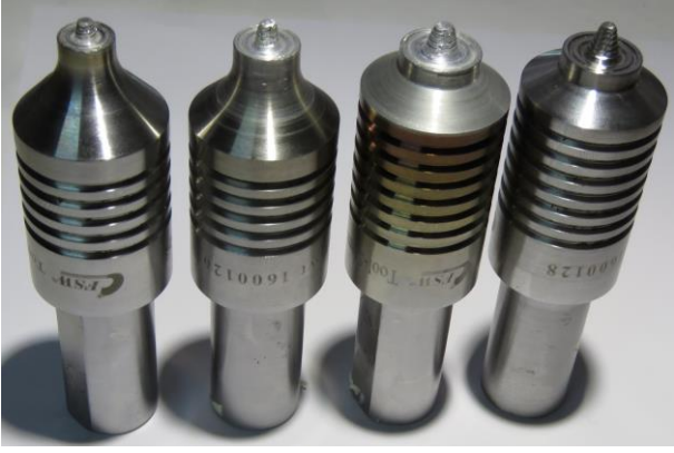
Şekil 1. Çalışmada kullanılan SKK takımları (sol baştan itibaren pim uzunlukları 2,8 mm, 3,8 mm, 4,8 mm ve 6 mm; omuz çapları da sırasıyla 10 mm, 12 mm, 15 mm ve 15 mm'dir).
