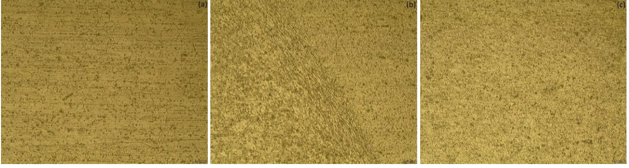
Şekil 7. 1000 devir ve 75 mm/min ilerleme hızında SKK yapılmış 4 mm kalınlıktaki levhada farklı bölgelerinin iç yapısını gösteren optik görüntüleri: (a) baz levha, (b) geçiş bölgesi (IEB+TMEB+DKB: ısıdan etkilenen bölge+termomekanik olarak etkilenen bölge+dinamik olarak yeniden kristalleşen bölge) ve (c) DKB.
