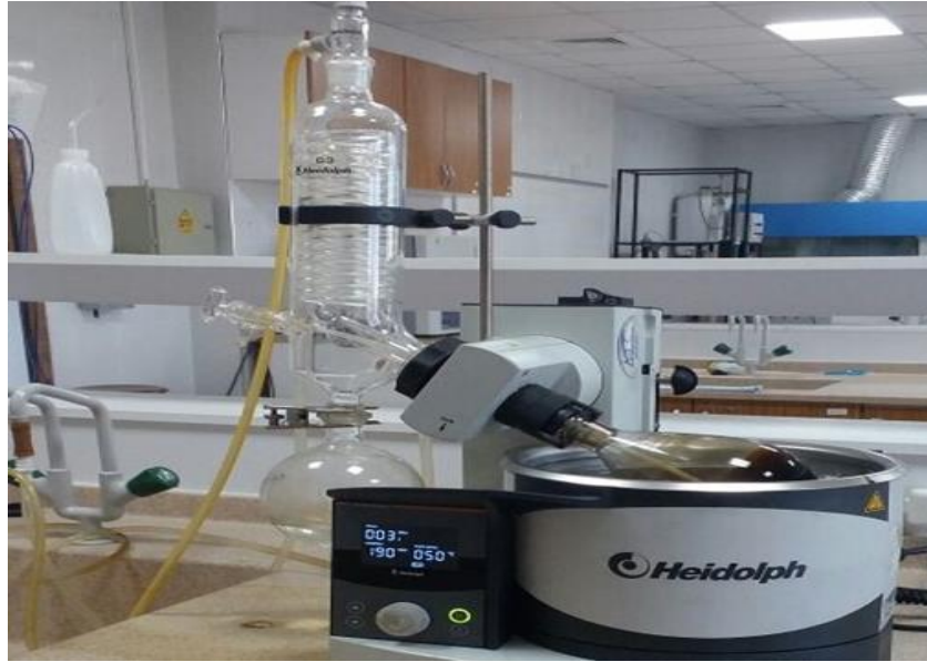
Resim 3.3 Heidolph Marka Rotary Evaporatörü ile Biyoyağdan Çözücünün Uzaklaştırılmasına Ait Görsel.
