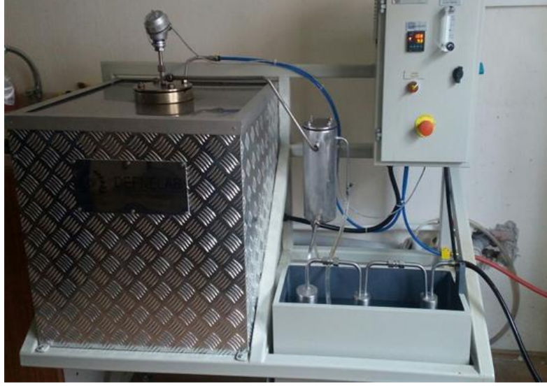
Resim 3.2 Piroliz Reaktörü Görseli.
