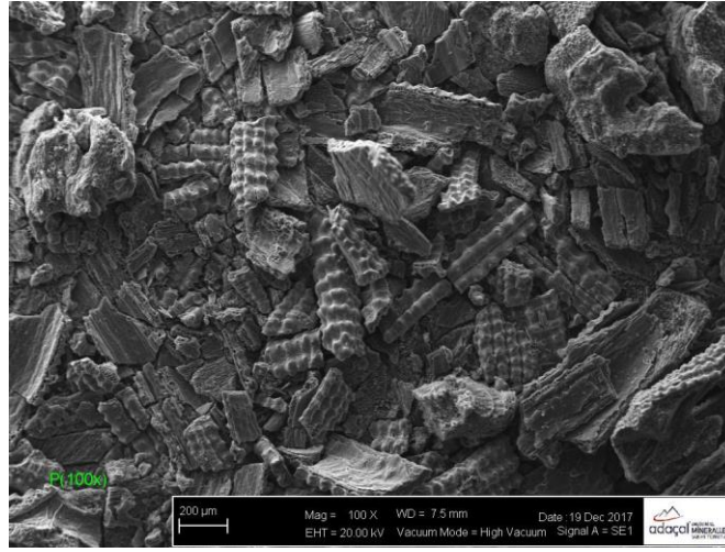
Resim 4.5 Pirinç Kabağunun Pirolyzi Sonucu Oluşan Çarın Sem Görüntüsü.
