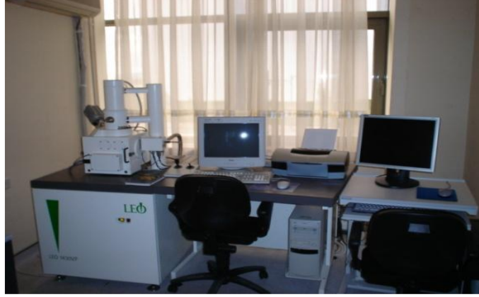
Resim 3.7 Mikroyapı ve tabaka kalınlığı belirlemek için kullanılan taramalı elektron mikroskobu.
