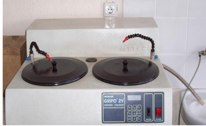
Resim 3.1 Numune zımparalama ve parlatma cihazı.
