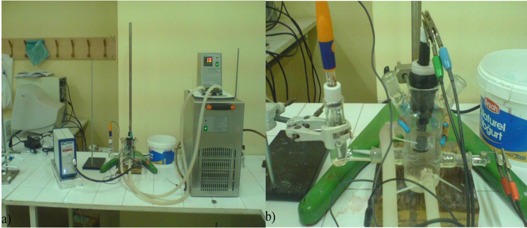
Resim 3.8 Korozyon deneylerinde kullanılan a) Deney Düzeneği b) Deney Hücresi.
