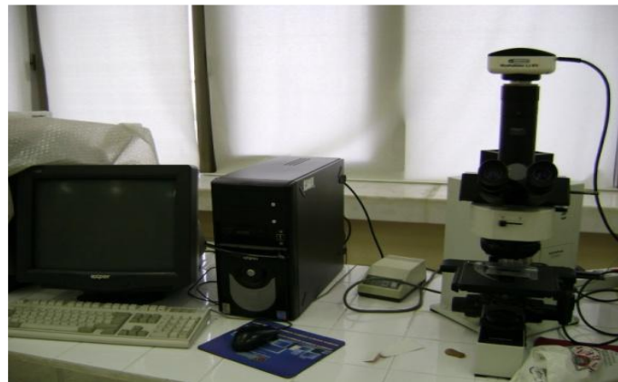
Resim 3.2 Mikroyapı görüntüleri için kullanılan optik mikroskop.
