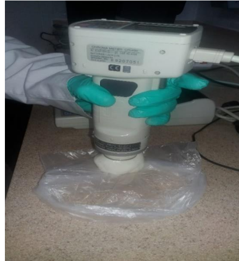
Resim 3.6 Peynir örneklerinin renk değerlerinin belirlenmesinde kullanılan cihaz.
