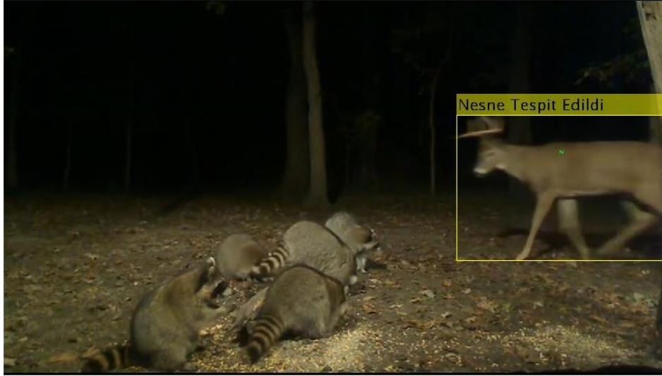
Resim 3.1 Alan testi ile birden fazla hareketli yaban hayvanının olduğu bir sahnede sadece hedeflenen nesnenin tespit edilmesi.
