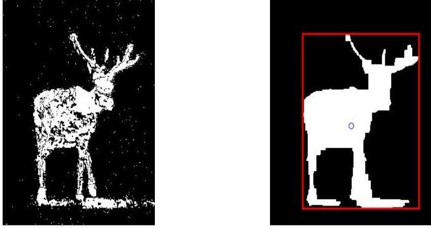
Resim 3.3 Fotokapan videosunda tespit edilen kızıl geyiğin arka plan görüntüsünün morfolojik uygulamalar ile onarılması.
