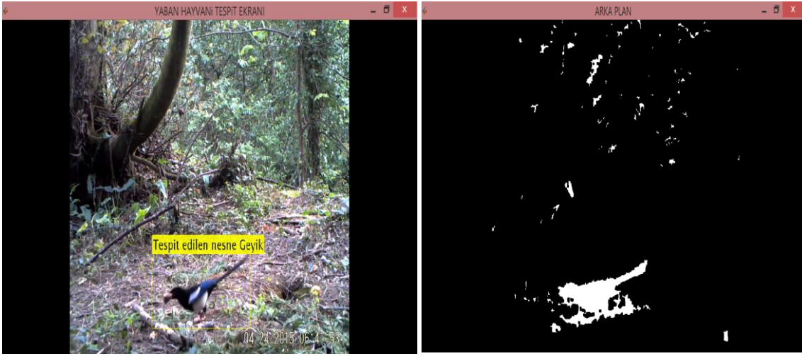
Resim 4.7 Alan testi ve öznitelik testinin yetersiz olduğu video sahnesi ile arka plan görüntüsü.
