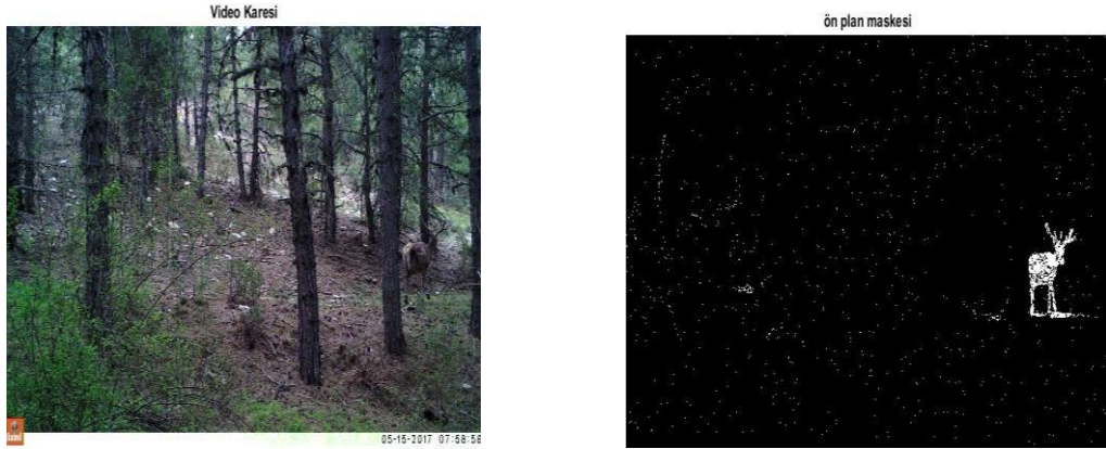
Resim 3.2 Fotokapan videosunda tespit edilen erkek kızıl geyiğin ön plan ve arka plan görüntüsünün çıkartılması.
