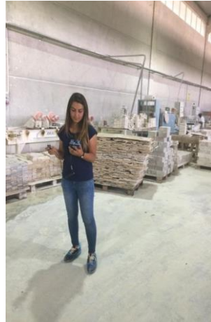
Resim 3.14 DELTA HD 2102.2 traverten fabrikası aydınlatma ölçümü.
