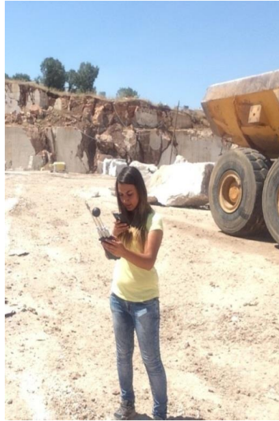
Resim 3.13 DELTA OHM-HD 32.3 traverten ocağı termal konfor ölçümü.
