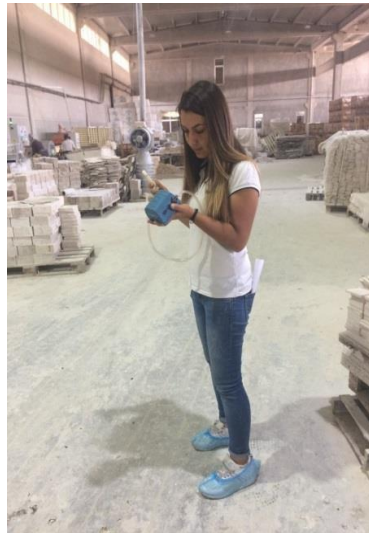
Resim 3.16 TSI AM510 traverten fabrikası toz ölçümü.
