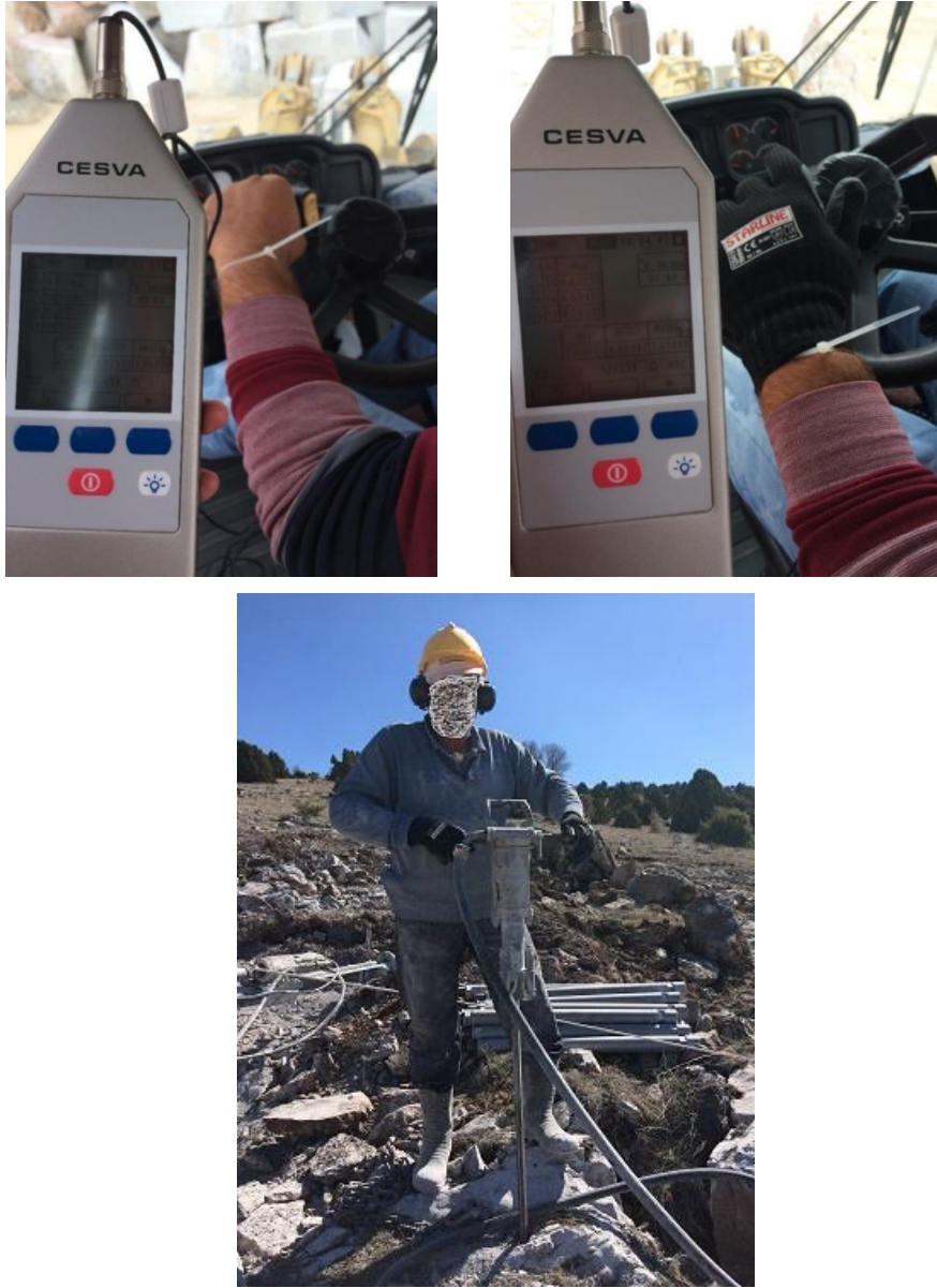
Şekil 3.5 El-kol titreşim ölçüm yerleri.
