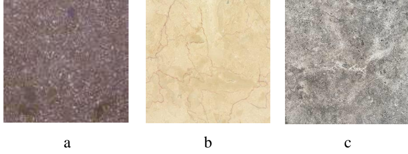
Şekil 2.2 a: Magmatik kökenli doğaltaş (andezit), b: Metamorfik kökenli doğaltaş (mermer), c: Sedimanter kökenli doğaltaş (traverten).
