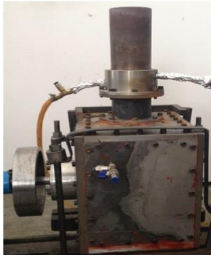
Resim 2.3 Karabulut ve arkadaşlarının imal ettiği beta tipi Stirling motoru (Karabulut et al. 2015).
