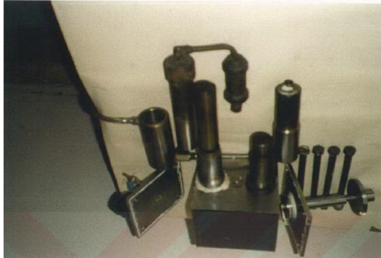
Resim 2.1 Demiralp tarafından yapılan Stirling motoru ve parçaları (Demiralp 2000).
