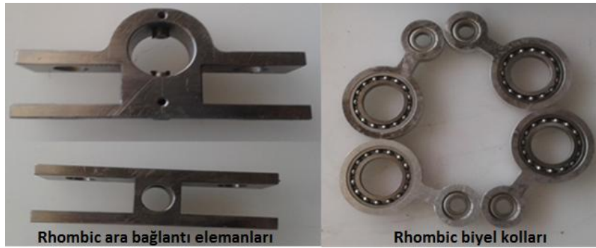
Resim 3.4 Rhombic biyel kolları ve ara bağlantı elemanları (Aksoy et al. 2016).
