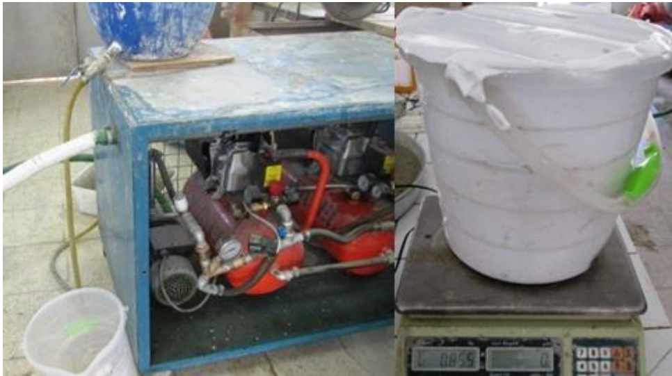
Resim 3.5 Köpük Makinesi ve Köpük Yoğunluğu Kontrolü.
