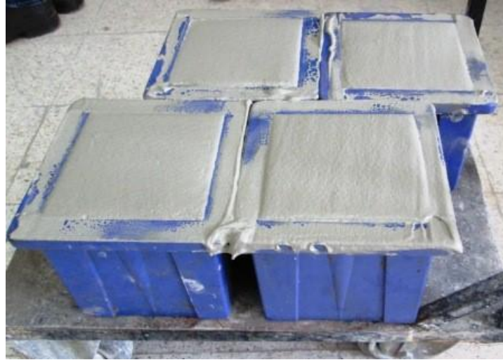
Resim 3.11 Köpük beton harcının etüve hazır hali.
