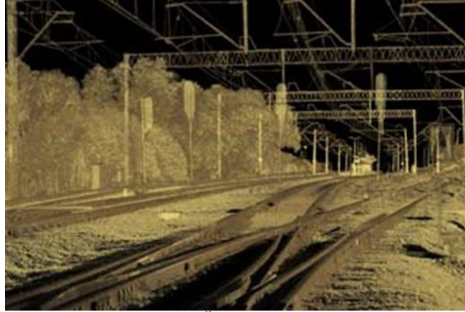
Resim 2.12 Lazer Tarayıcı Cihaz Yapılmış Örnek Demiryolu Hattı Çalışması.
