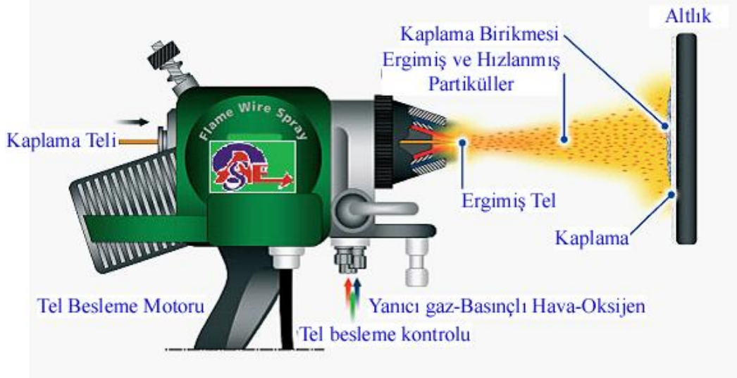
Şekil 4.1 Alev püskürtme yöntemi (İnt.Kyn.1).
