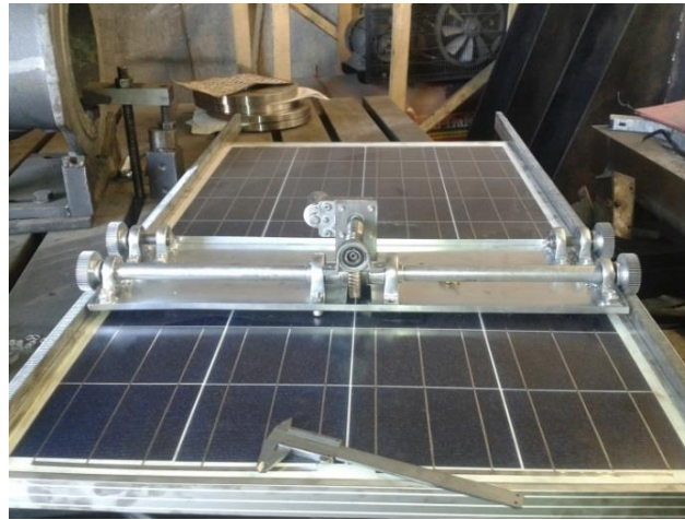
Şekil 3.11 Temizleme sistemi mekanik görünümü.
