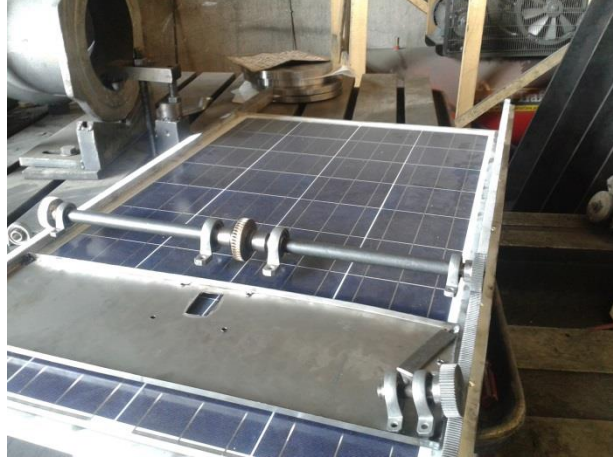
Şekil 3.7 Kremiyer dişli ve karşılık dişlisi montajı.
