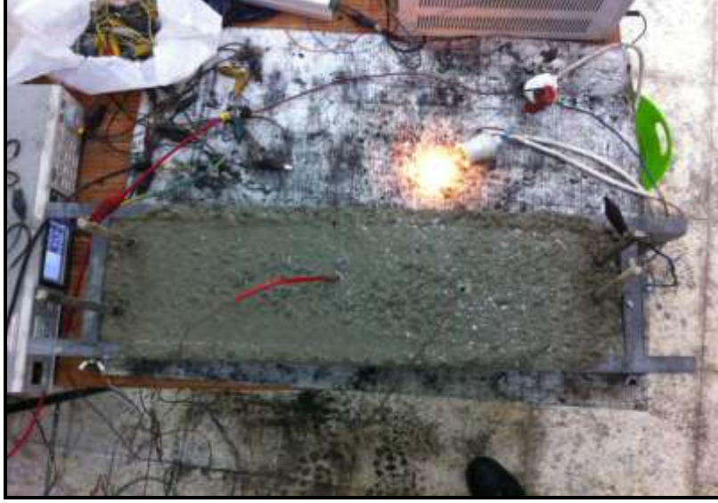
Resim 4.3 Betonarme sisteme ampül bağlanması.
