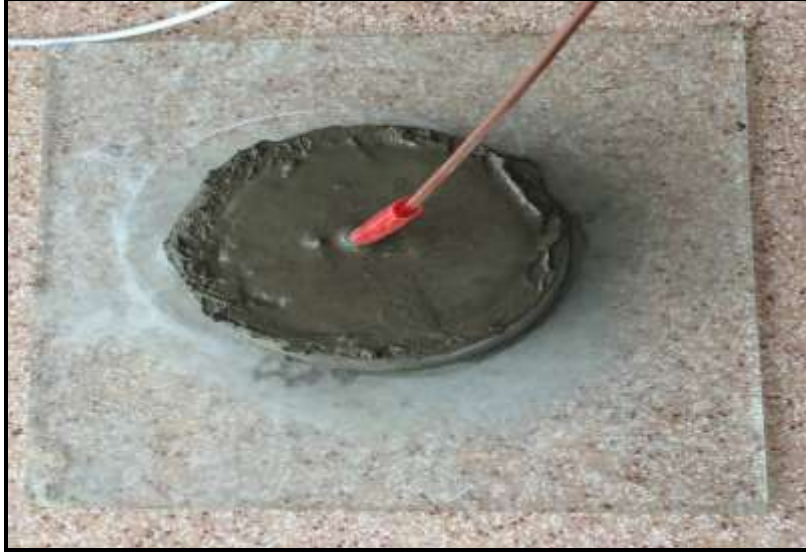
Resim 3.4 Çimento pastasında sıcaklık ölçümü.
