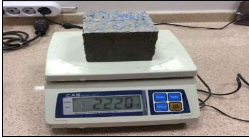
Resim 3.8 Numunelerin doygun yüzey kuru ağırlıklarının tartılması.
