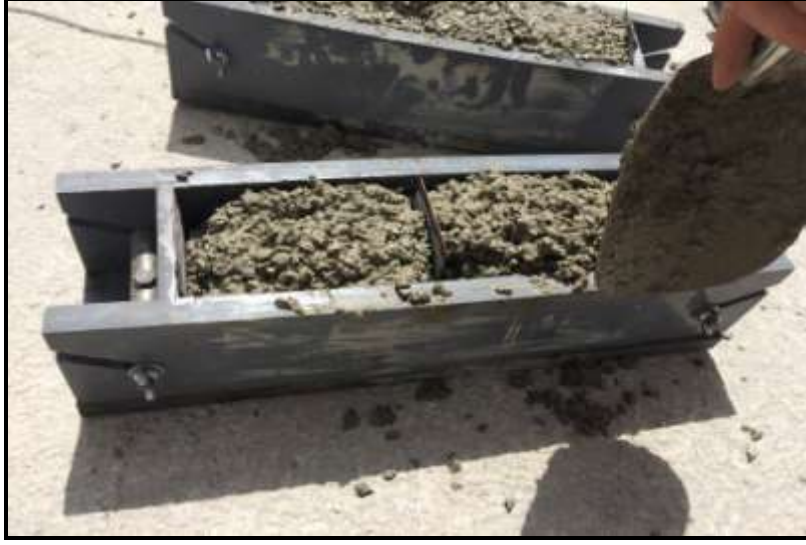
Resim 3.2 Betonların kalıplara yerleştirilmesi.
