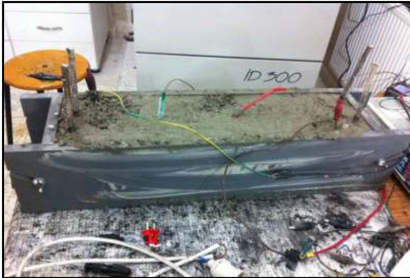
Resim 4.4 Betonarme sisteme AC gerilim uygulanması.
