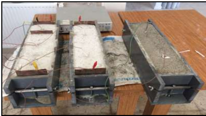
Resim 4.1 80 V AC gerilim uygulanan 1 günlük betonların görünümü.
