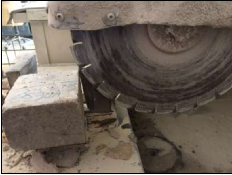
Resim 3.3 Beton numunelerinin testereyle kesilmesi.
