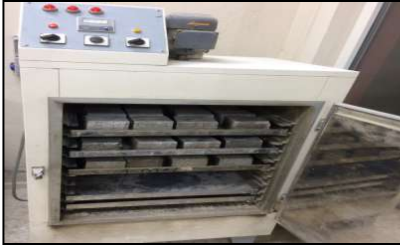
Resim 3.9 Numunelerin etüve konulması.
