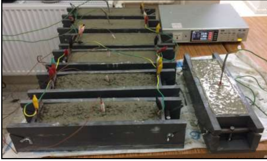
Resim 3.6 Betonlara AC gerilim uygulanması.
