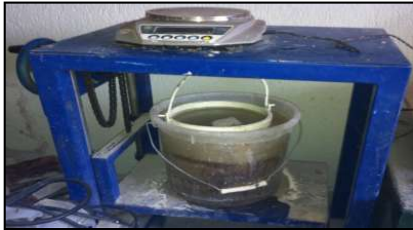
Resim 3.7 Numunelerin sudaki ağırlıklarının ölçülmesi.
