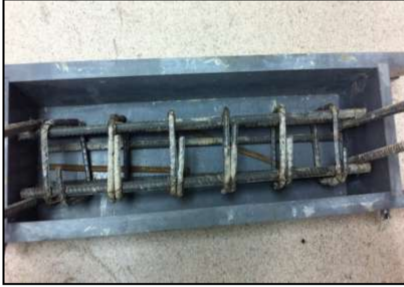
Resim 4.2 Donatılı beton hazırlanması.
