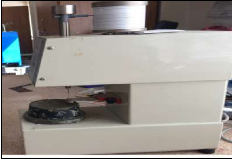
Resim 3.5 Çimento pastasında priz süresi ölçümü.
