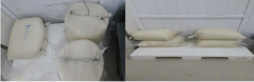
Resim 3.4 Baskıda keten çuvallara dolumu ve keten çuvallarda baskı işlemi.
