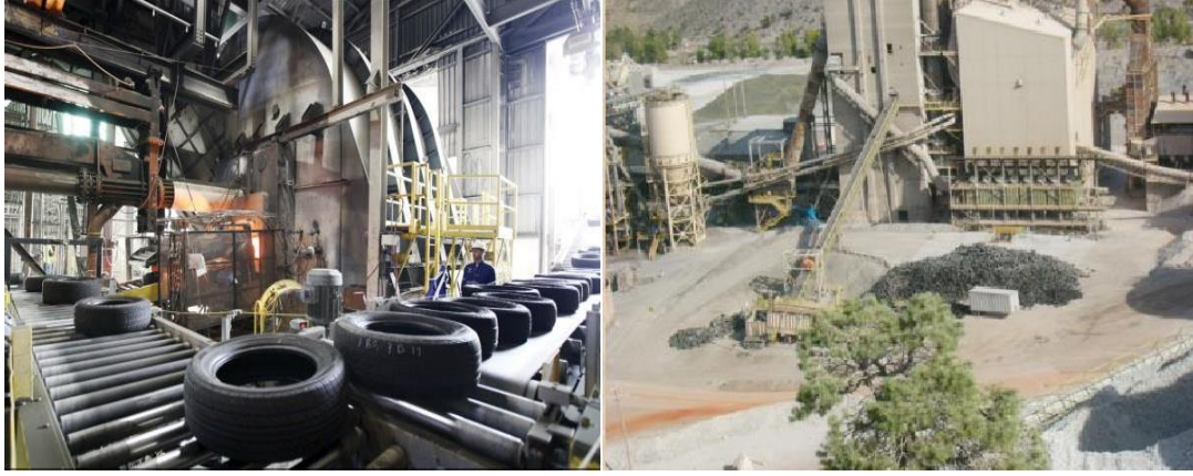
Resim 2.3. Çimento fabrikasında atık lastik kullanımı a) Yakma fırınına doğru giden lastikler (İnt. Kyn. 10). b) Depolama alanında bekleyen lastikler (İnt.Kyn. 11).
