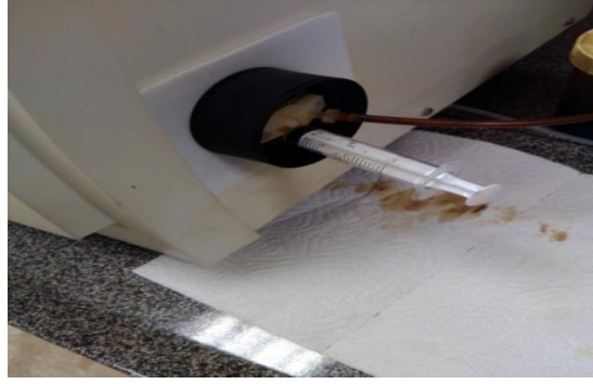
Resim 3.2 Numunenin cihaza enjekte edilmesi.
