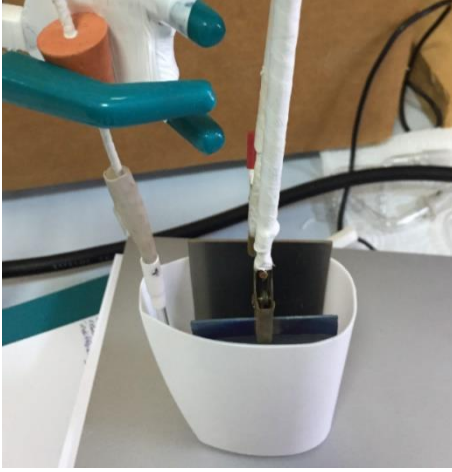
Resim 3.5 DV yöntemi ile Pt nano parçacıklarının katkılanması
