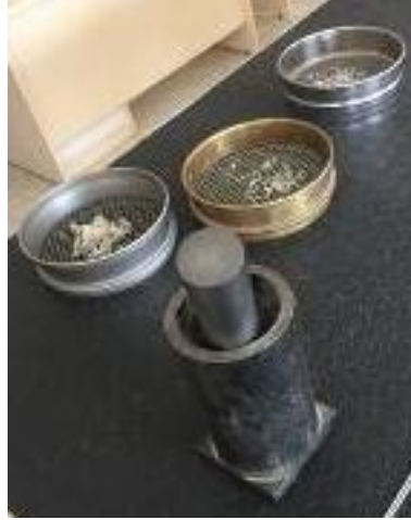
Resim 4.2 Kaya tuzlarını kırma ve boyut ayrıştırma işlemi.
