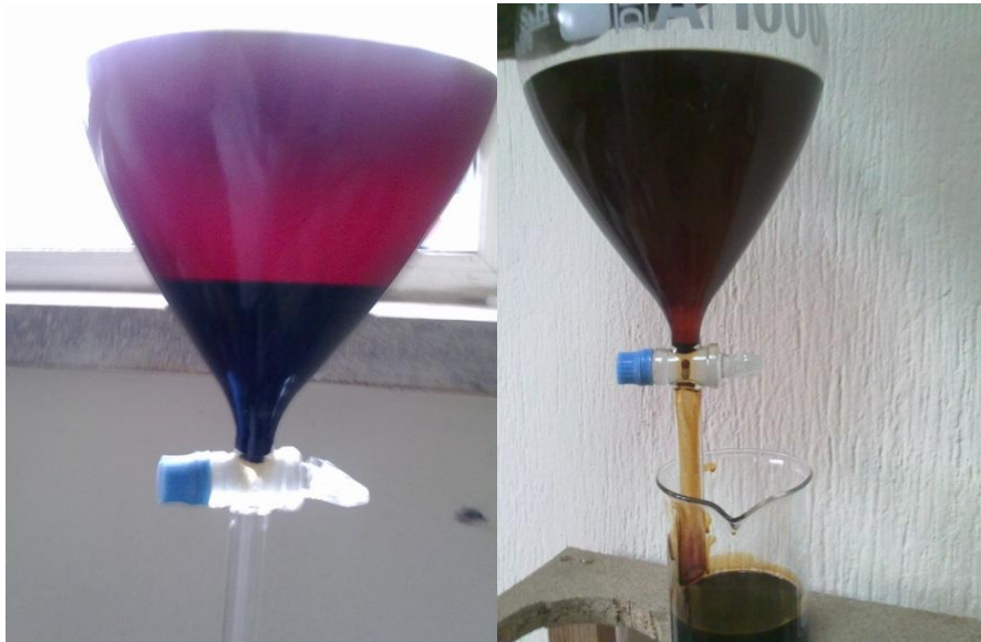
Resim 3.2 Ayırma hunisine alınmış balık yağ metil esteri-gliserin karışımı ve bunların ayrılmış hali.
