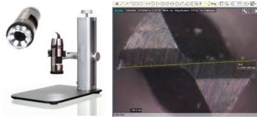
Resim 3.3 Dino Lite USB 2.0 optik mikroskop ile takım çapının ölçümü.
