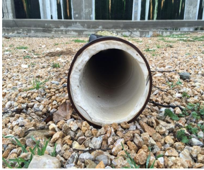
Resim 5.15 Jeotermal akışkanın çıkış noktasındaki borunun iç yüzeyinde \text{CaCO}_3 kabuklaşması.
