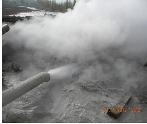
Resim 5.11 2010 sonrasında açılan AF25 nolu jeotermal sondaj kuyusu.
