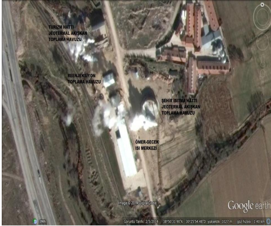
Resim 5.21 Ömer-Gecek sahasındaki ısı merkezi ve toplama havuzlarının yerleşimi.
