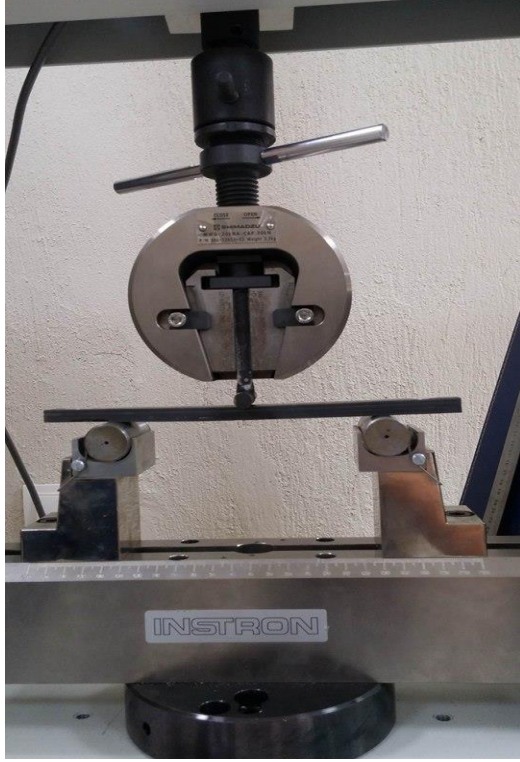
Şekil 3.38 Bambunun hegzagonal ve homojen yapıdaki kirişlere 3 nokta eğme testi uygulanması.
