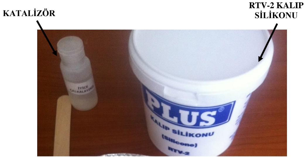
Şekil 3.16 Kalıp silikonu ve katalizör (sertleştirici) malzeme.
