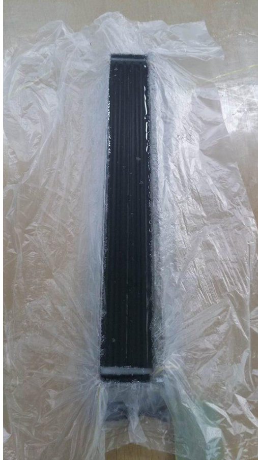
Şekil 3.35 Üretilen kirişin silikon kalıptan çıkarılmış hali.
