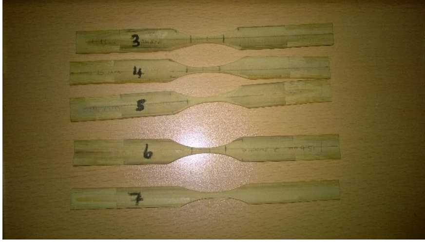
Şekil 3.3 Kesit alanları küçültülmüş çekme numuneleri.
