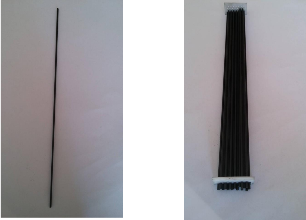
Şekil 3.33 Üretilen plakalara karbon çubukların montaj aşaması.
