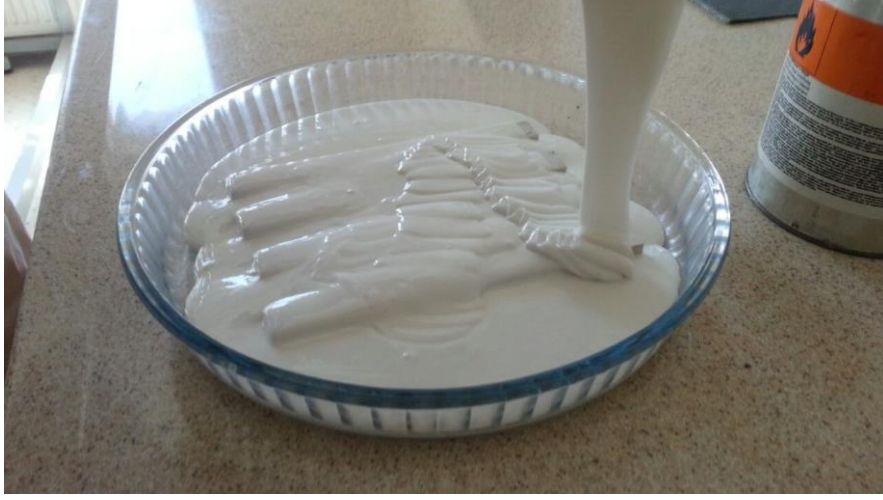
Şekil 3.22 Kalıba silikon malzemenin dökülme aşaması.
