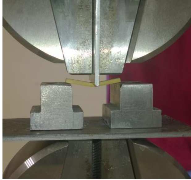
Şekil 3.11 Üç nokta eğme numunesinin cihaza bağlanmış hali.
