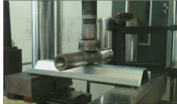
Şekil 4.1 Yapılan üç nokta eğme deneyi ölçüleri ve deney cihazı
