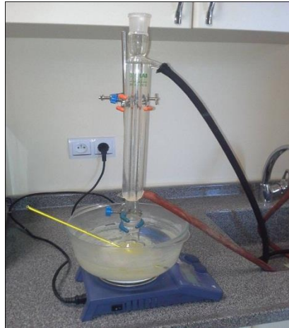
Resim 3.1 Optimizasyon ve biyodizel üretiminde kullanılan deney düzenegi.
