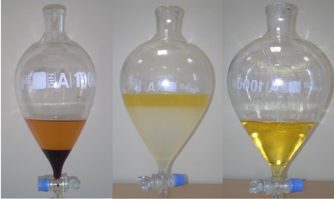
Resim 3.7 Ayırma hunisi ile gliserin fazını ayırma işlemi.
