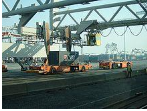
Resim 2.9 Konteyner terminalinde ; AGV ye konteyner yüklenme süreci.
