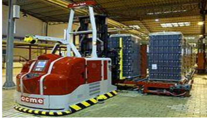
Resim 2.2 Güvenlikli lazer sensörlü forklift tam otomatik AGV (İnt.Kyn.14).
