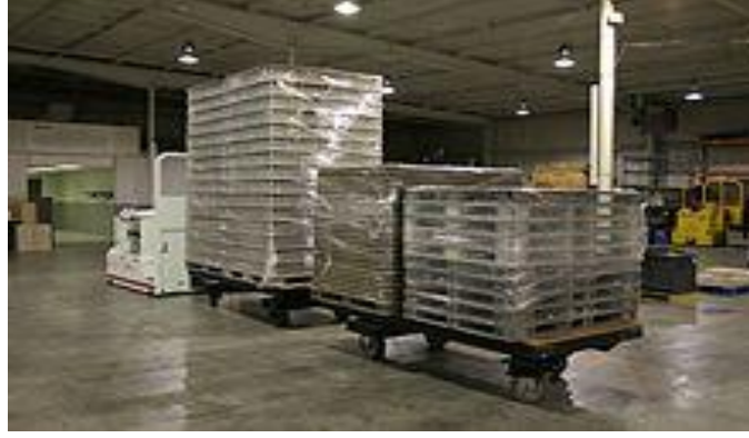
Resim 2.4 Tugger AGV bir depo içerisinde birden çok römorku çekiyor.
