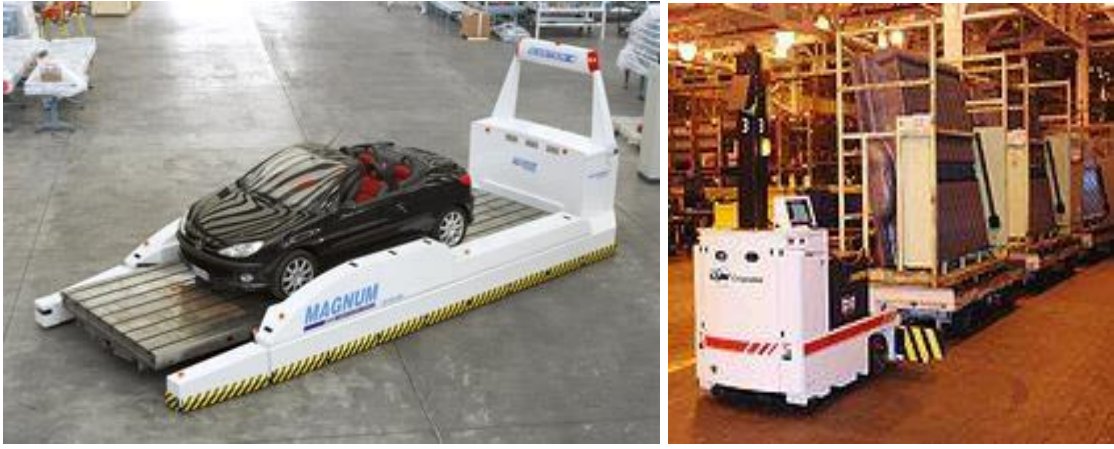
Resim 2.13 Otomobil gövde parçalarının üzerinde bulunduğu yük araçlarını çeken tekerlekli bir Tugger AGV.
