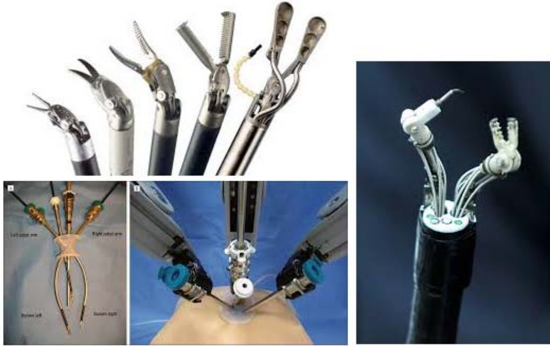
Şekil 1.5 Robotik cerrahi için geliştirilmiş çeşitli end efektör tipleri.
