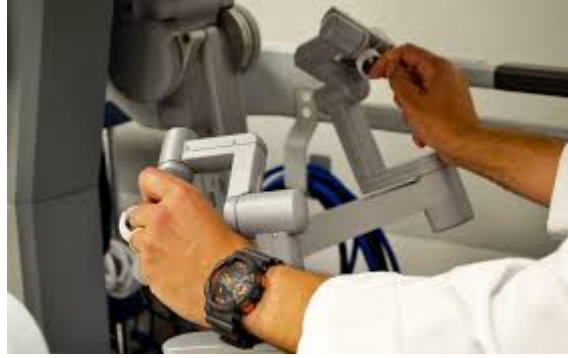
Şekil 1.2 Robotun kontrolü için kullanılan bir master sistemi.
