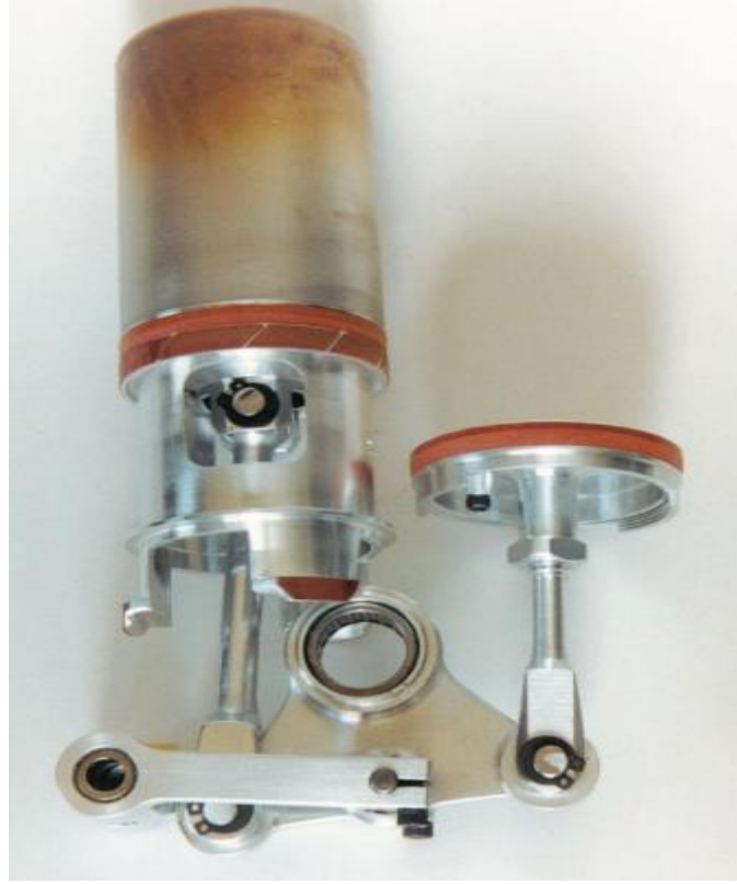
Resim 2.3 Ross Yoke hareket iletim mekanizması (Erol 2011).
