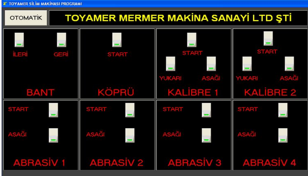
Şekil 3.12 Kumanda kontrolünü ve iletişimini sağlayan yazılım programının manuel yardımcı menüsü.
