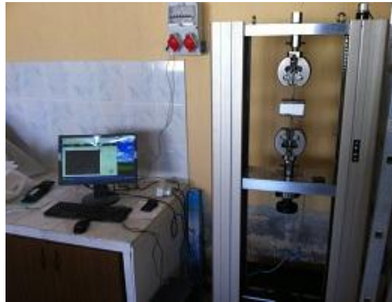
Resim 4.16 Çekme testi için kullanılan cihaz.
