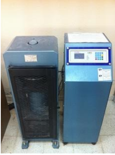
Resim 4.10 Basınç dayanımı cihazı genel görünümü. Resim 4.11 Basınç dayanımı cihazı.
