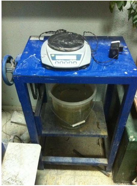
Resim 4.17 Hassas terazi arşimet terazisi düzeneği.
