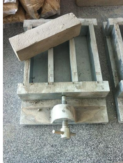
Resim 4.9 Kalıptan çıkartılmış sertleşmiş harç.
