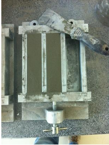
Resim 4.8 Kalıba dökülmüş taze harç.
