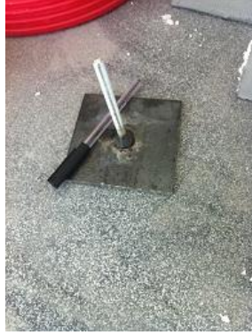
Resim 4.12 Vida kaynatılmış 5mm lik saç levha.
