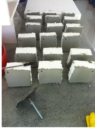
Resim 4.14 Saç levha ve harç uygulanmış EPS strafor numuneleri genel görünümü.
