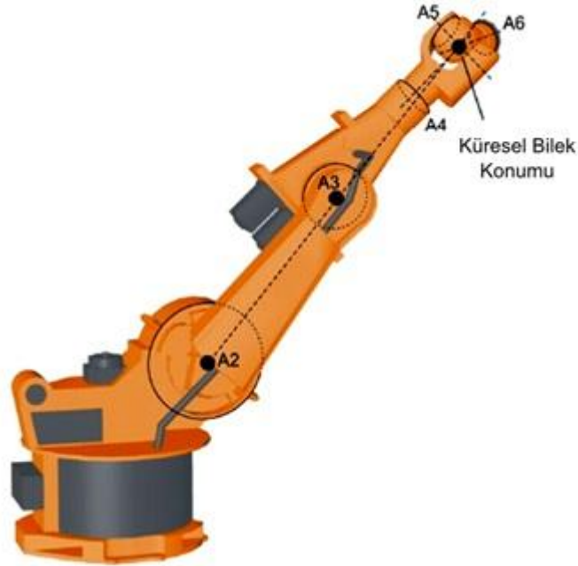
Şekil 2.9 Kuka KR210 endüstriyel robot manipülatörünün genişletilmiř konum tekillik durumu (Anonim 2003).
