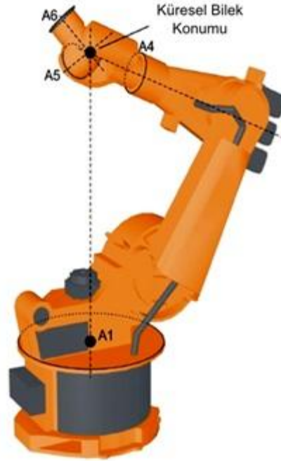
Şekil 2.8 Kuka KR210 endüstriyel robot manipulatörünün baş üstü tekillik durumu (Anonim 2003).
