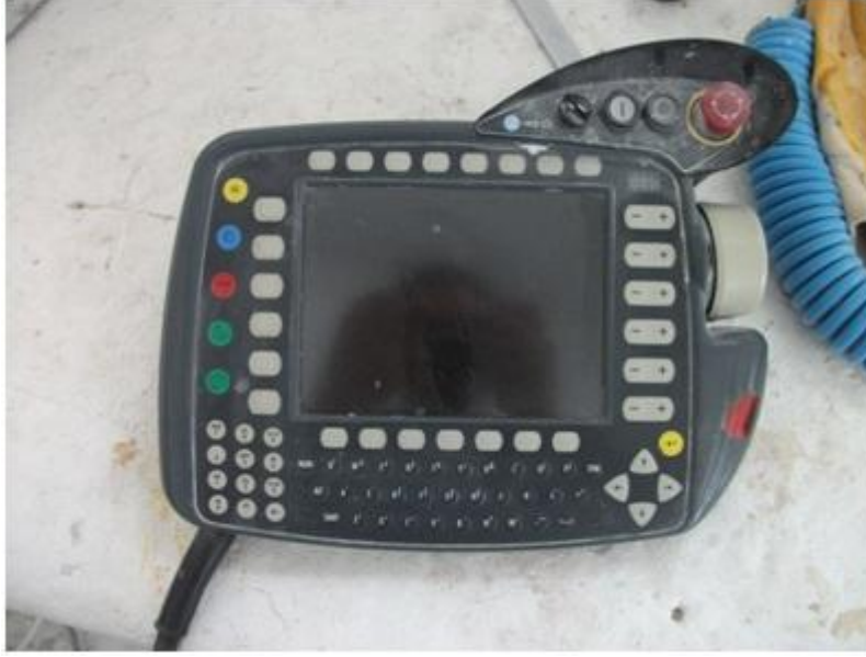
Şekil 3.3 Kuka KCP el kumanda paneli.
