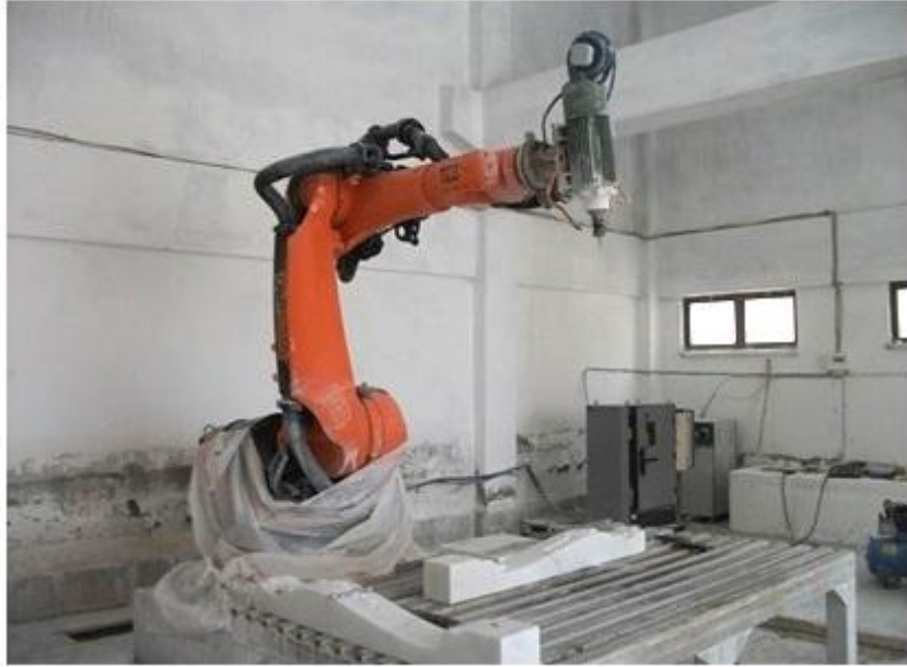
Şekil 3.1 Kuka KR210 altı eksenli küresel bilekli endüstriyel robot manipülatörü.
