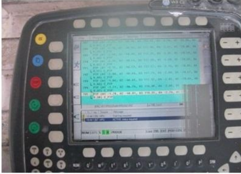
Şekil 4.6 Endüstriyel robotun eksen açıları ile hedef tanımlanarak yapılan robot programının KCP el kumanda paneli ekranındaki görüntüsü.
