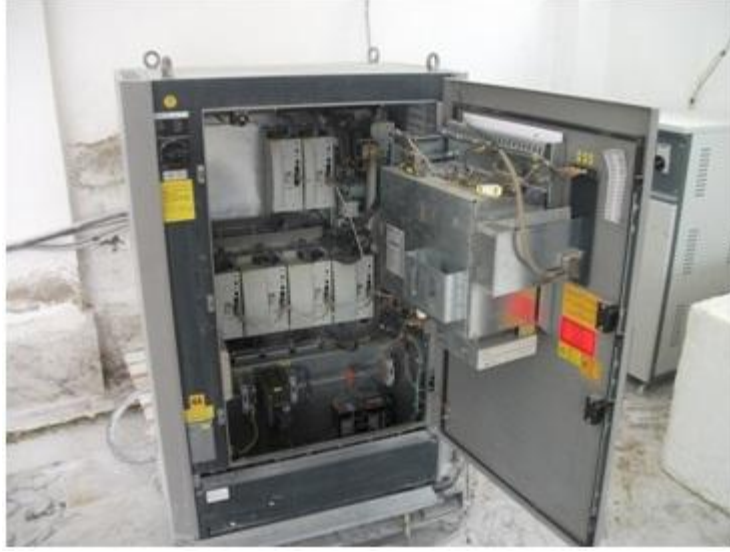
Şekil 3.2 VKRC2 Kuka endüstriyel robot kontrol kabini.
