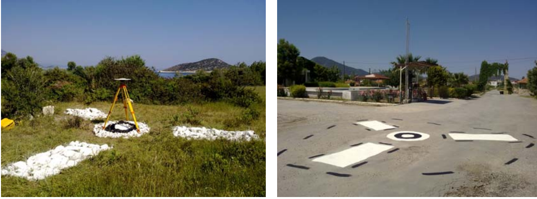
Şekil 2.9 Fotogrametrik nirengi noktası resimleri
