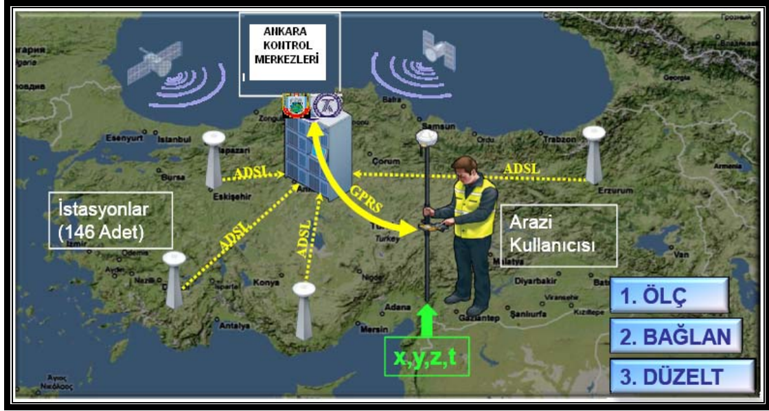
Şekil 2.7 TUSAGA-AKTİF sisteminin çalışma prensibi
