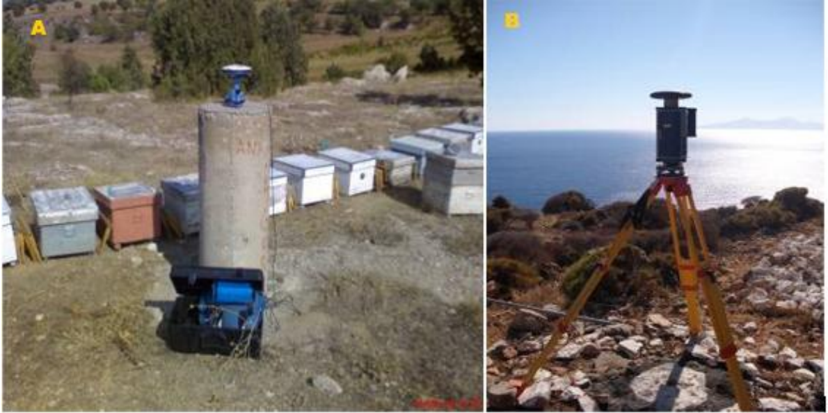
Resim 6.1 A) Pilye üzerinde B) Alet sehпасı üzerinde GNSS alıcısı.
