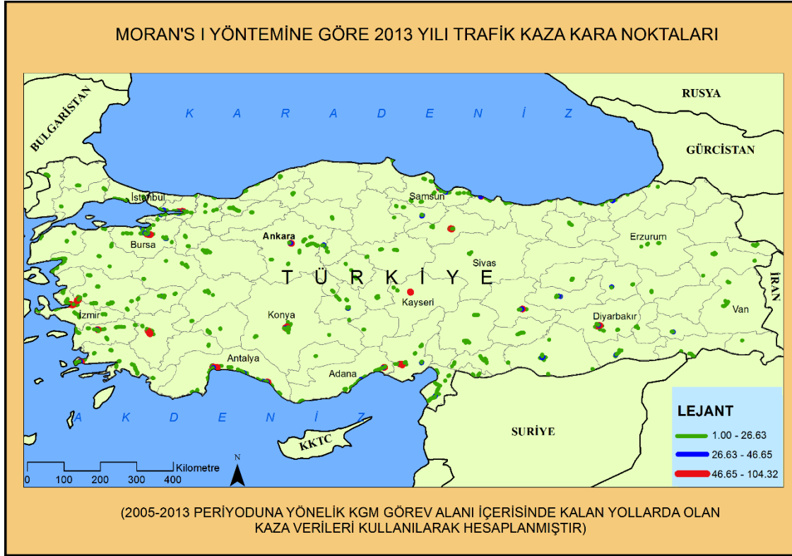
Şekil 4.14 Moran's I yöntemine göre kara nokta olarak belirlenen segmentler.
