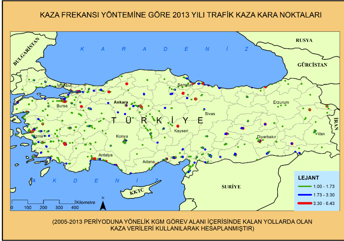
Şekil 4.6 Kaza frekansı yöntemine göre kara nokta olarak belirlenen segmentler.
