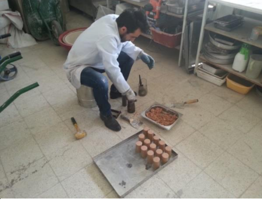
Resim 3.5 Kaolin kilinin şekillendirilmesi.
