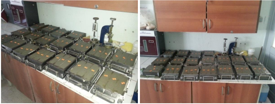
Resim 3.8 Puzolanik aktivite deneyleri için dökülen harç örnekleri.
