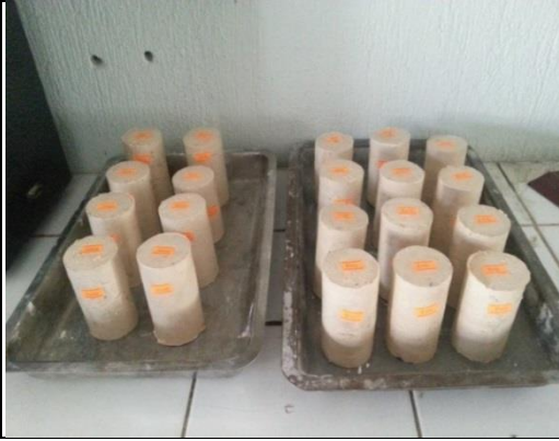
Resim 3.6 Metakaoline dönüştürülmek için hazırlanan kaolin kili örnekleri.
