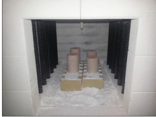
Resim 3.7 Metakaoline dönüştürülecek örneklerin fırına yerleştirilmesi.
