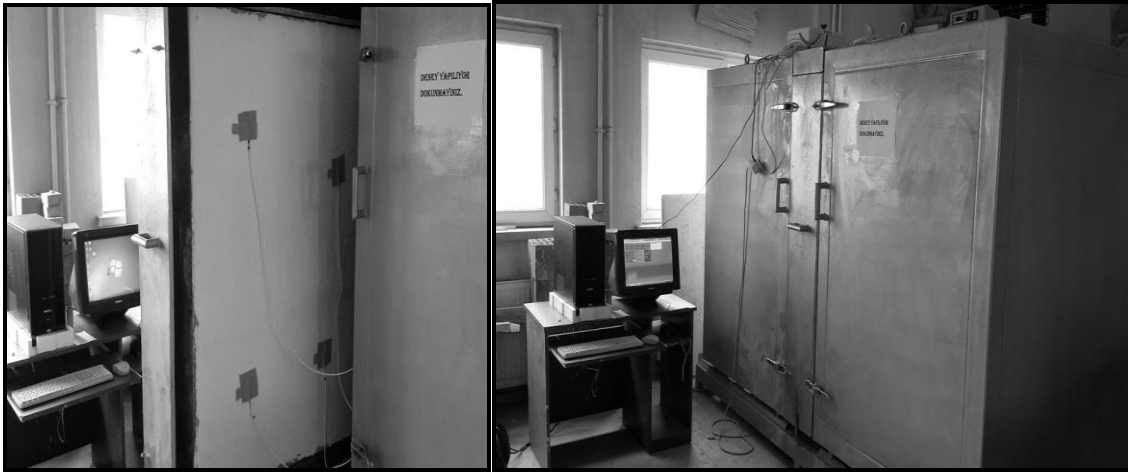
Resim 4.7 Isı iletkenlik cihazı içerisindeki mantolama yapılmış duvarın görünümü.
