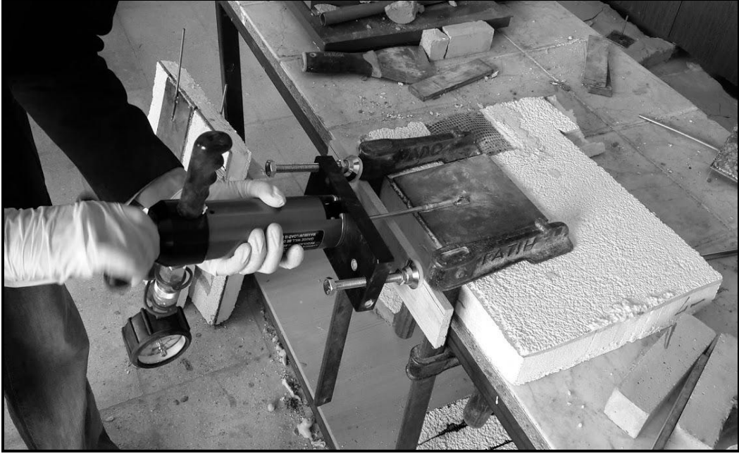
Resim 4.10 Sıvalı yalıtım levhalarında kayma dayanımının belirlenmesi.
