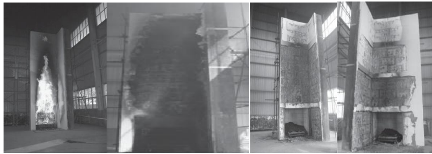
Resim 3.1 Test duvarı yüzeyine bariyerli kaplanmış EPS'nin yangındaki davranışı.
