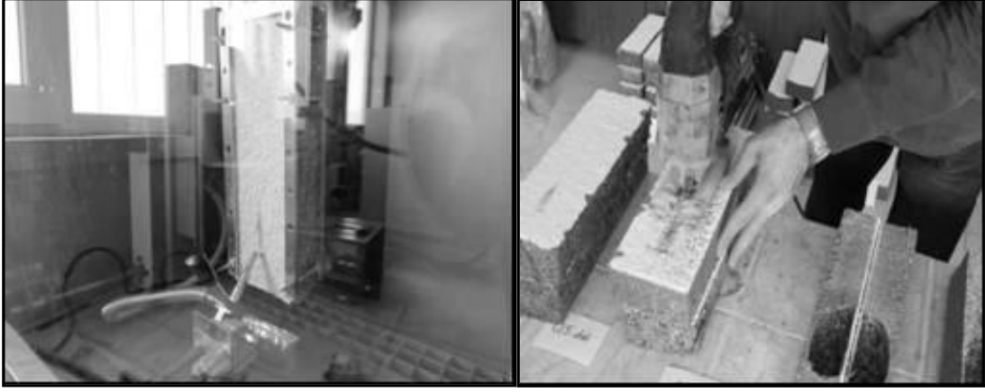
Resim 4.5 Sıvalı kaplamanın yangın sonrası iç yüzeyinden bir görünüm.
