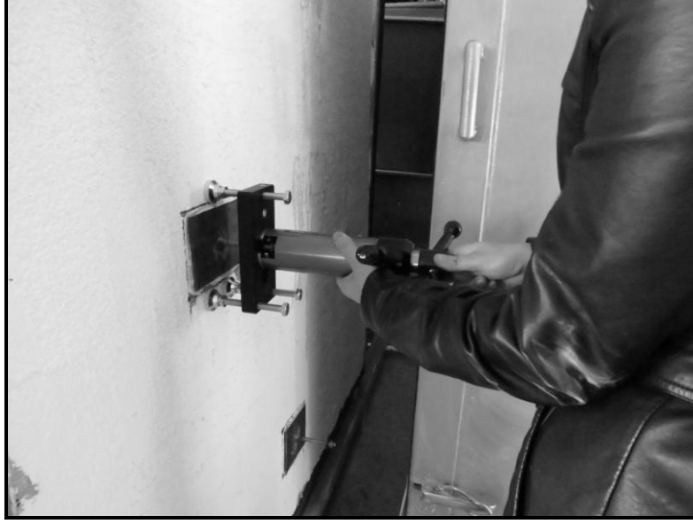
Resim 5.6 Düşey düzlemde sıva yapışma deneyi.
