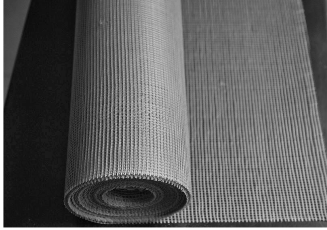
Resim 2.3 Mantolama kompozitlerinde kullanılan sıva filesi.
