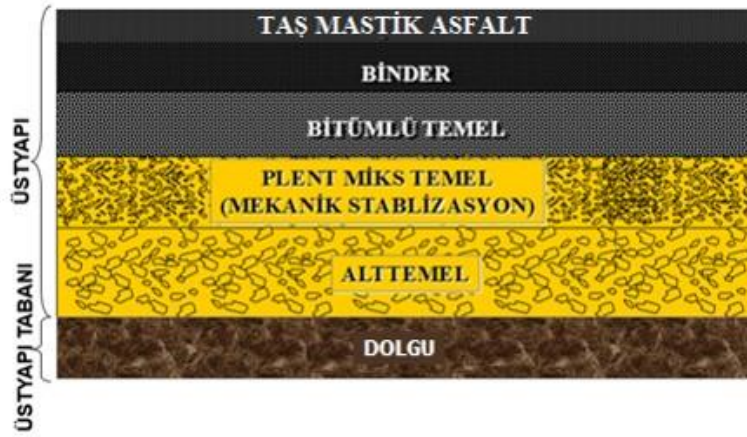
Resim 2.2 Asfalt kaplamasının uygulama katmanları (Int. Kyn.3).
