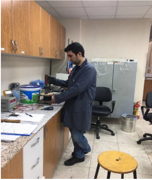
Resim 3.9 İletken asfalt numunelerinin elektrik akım ile ısıtılması.
