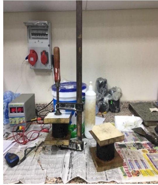
Resim 3.9 İletken asfalt numunelerinin elektrik akım ile ısıtılması.
