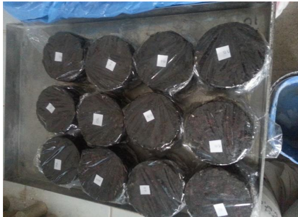
Resim 3.5 Marshall briketlerinin kalıplardan çıkartılmış durumu.
