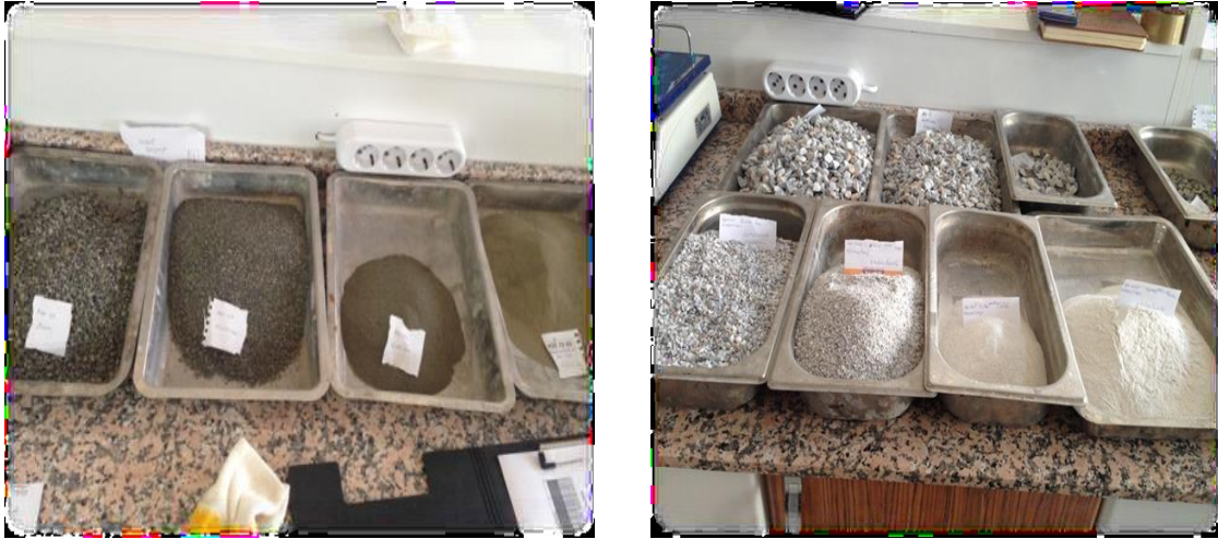
Resim 3.1 Asfalt karışımı için yıkanıp elenen kireçtaşı ve bazalt numuneleri
