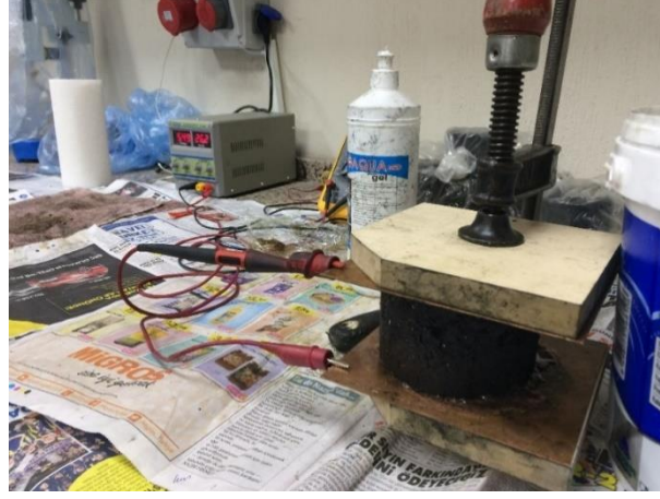
Resim 3.8 İki elektrotlu yöntemi ile öz direnç ölçümü.
