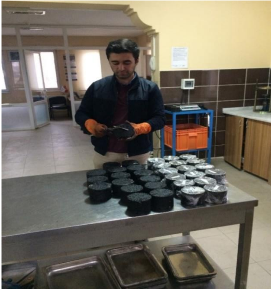
Resim 3.6 Kumpas ile numunenin yüksekliğinin ve sudaki ağırlığının belirlenmesi.
