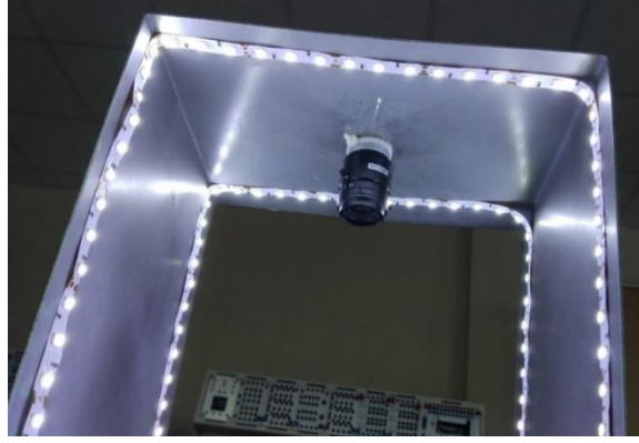
Şekil 3.7 Aydınlatma amacı ile kullanılan kabin ve aydınlatma düzeneği
