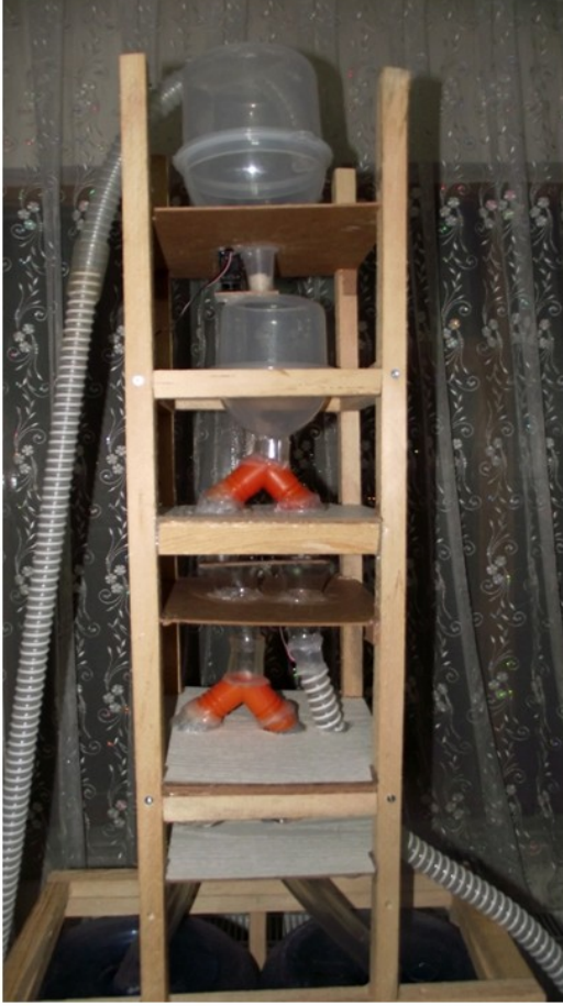
(a) Silo üst bunker ve tartı deposu
