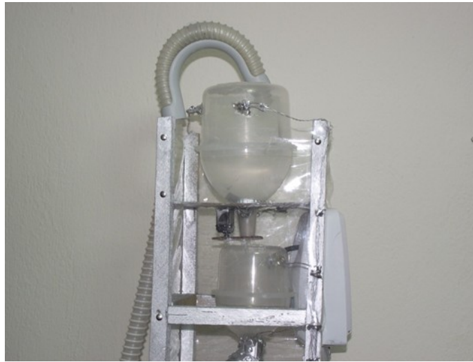
Şekil 4.13 İlaçlama ünitesinin yerleştirilmiş hali
