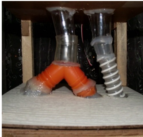
Şekil 4.10 (Y) şeklindeki borular değiştirildi
