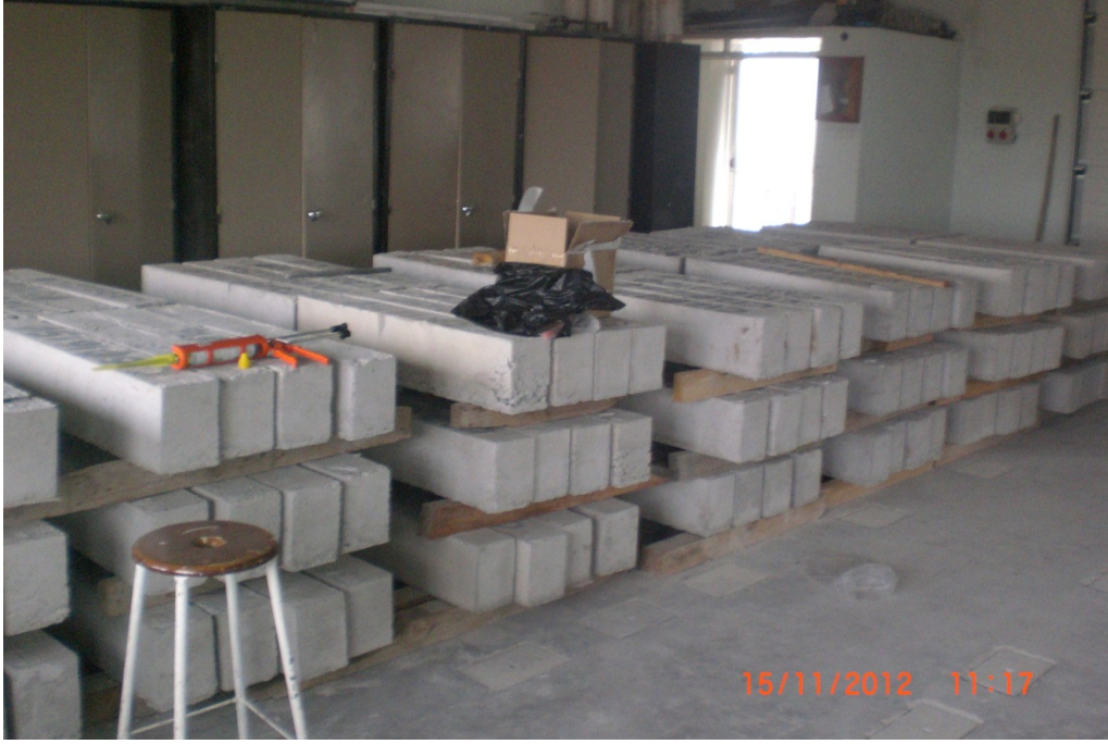
Resim 3.5 Birleştirilmesi yapılmış Belçika kiriş deney numuneleri
