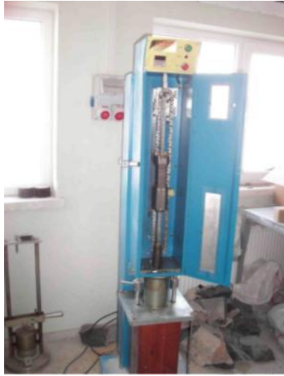
Resim 3.10 Çalışmada Marshall Deney Numunelerini Hazırlamak İçin Kullanılan Otomatik Tokmak
