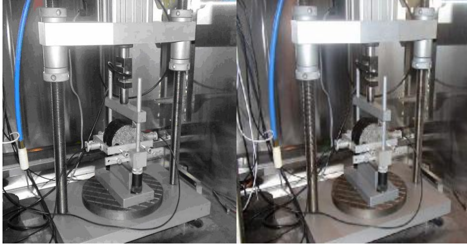
Resim 3.14 İndirekt Çekme Aletine Numunelerin Yerleştirilmesi
