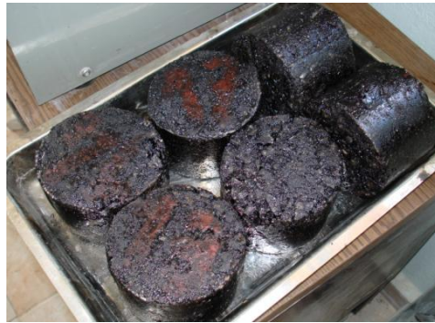
Resim 3.13 Marshall Deneyi Sonrası Numuneler
