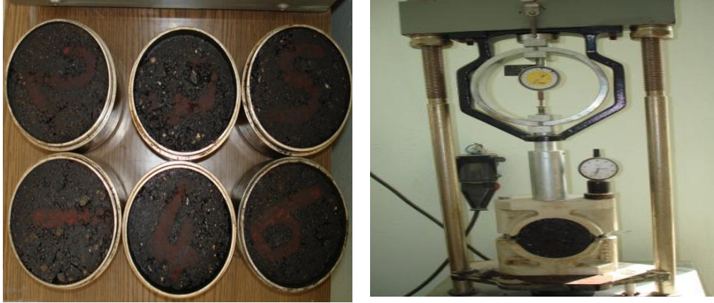
Resim 3.12 Deney Numuneleri ve Bir Marshall Deney Cihazı
