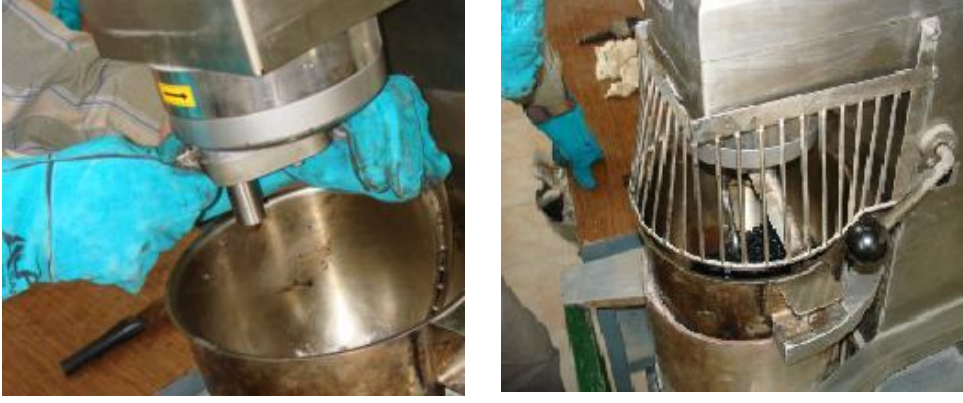
Resim 3.9 Çalışmalarda Kullanılan Isıtıcı Mekanik Asfalt Karıştırıcısı ve Bir Karıştırma İşlemi
