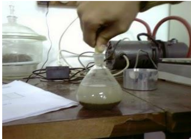
Resim 3.6 Fillerin Özgül Ağırlık Ölçümü
