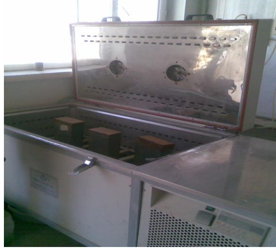
Resim 3.5 Agregada Donma-Çözülme Test Aleti
