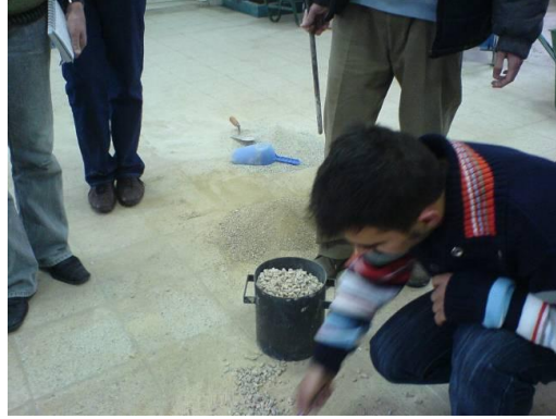
Resim 3.1 Sıkışık Birim Ağırlık Tayini Deney Yapımı
