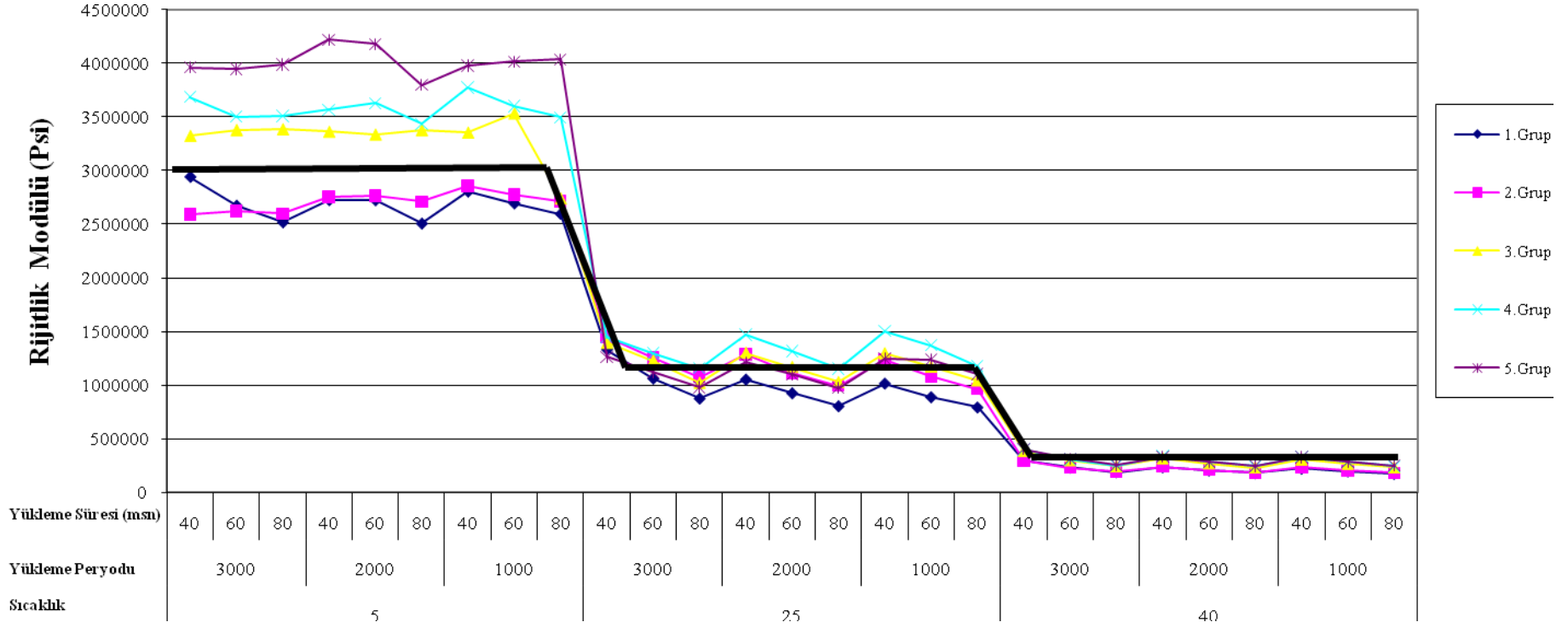
Şekil 4.17 Farklı Sıcaklık, Yükleme Periyodu ve Süresi Altında Farklı Yüzdelerde Filler İlaveli Numunelerin Rijitlik Modülü Değişimleri
