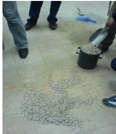
Resim 3.2 Gevşek Birim Ağırlık Tayini Deney Yapımı
