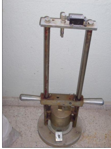
Resim 3.4 Agregada Darbelenme Deęeri Tayini İin Deney Cihazı
