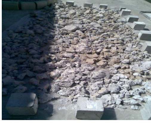
Resim 1.2 Granit atık Çamurunun Güneş Enerjisi ile Kurutulması
