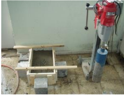
Şekil 3.6 Karot Alma Cihazının Sabitleştirilmesi
