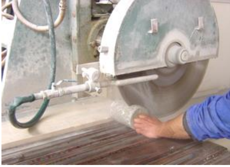
Şekil 3.7 Karot Numunelerin Baş Kesme İşlemi
