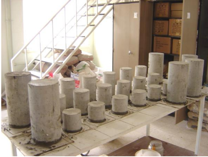
Şekil 3.8 Silindir Numunelerin Başlıklanması İşlemi
