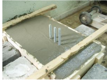
Şekil 3.6 Karot Alma Cihazının Sabitleştirilmesi
