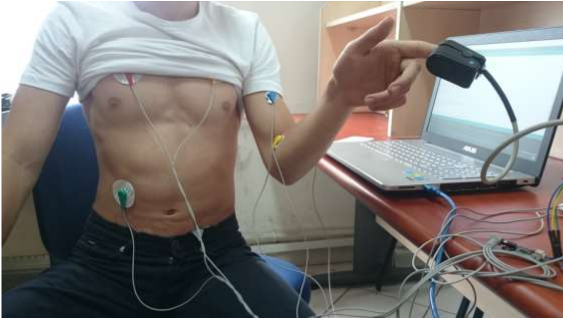
Resim 4.4 Tasarlanan sistemde elektrotların vücuda bağlanması.
