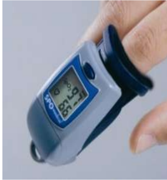
Şekil 3.14 Pulse Oksimetre ve çalışma mantığı.
