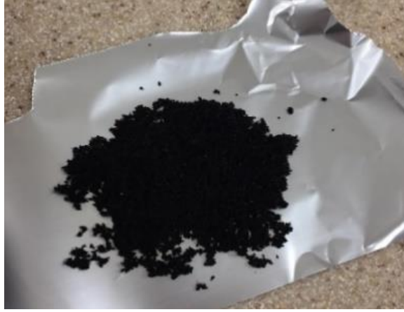
Resim 3.7 Yıkılmış toz aktif karbon numunesi.
