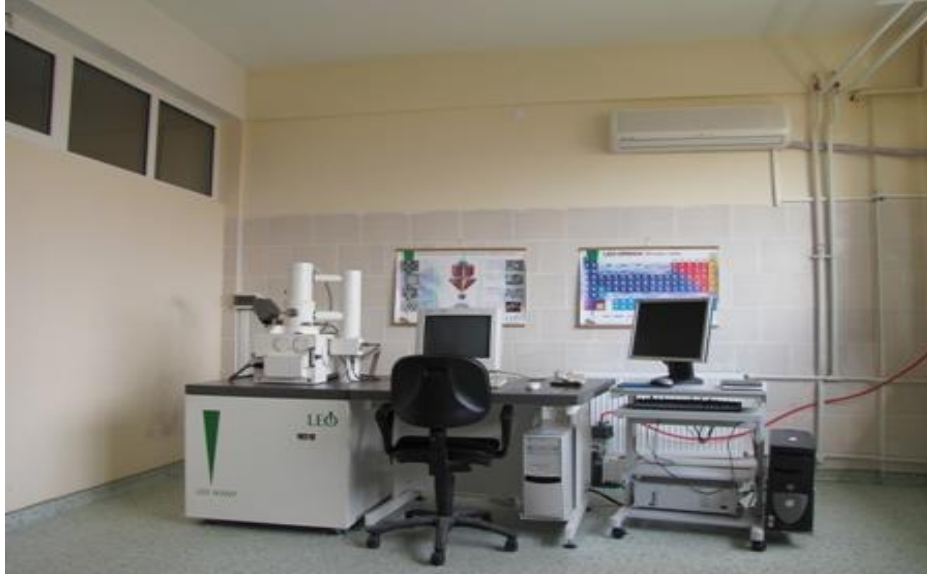
Resim 3.9 Mikroyapı analizlerinin gerçekleştiği SEM analiz cihazı.
