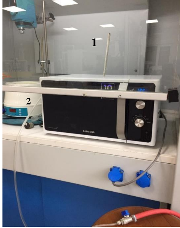
Resim 3.3 Hızlı mikrodalga destekli piroliz sistemi; (1) mikrodalga fırını üst baca sistemi, (2) mikrodalga fırına azot gazı giriş noktası.
