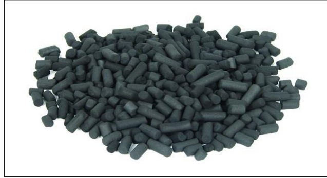
Resim 2.7 Silindir aktif karbon (İnt.Kyn.10).
