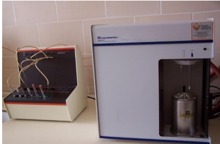
Resim 3.8 Yüzey alanı ölçümlerinde kullanılan BET cihazı.
