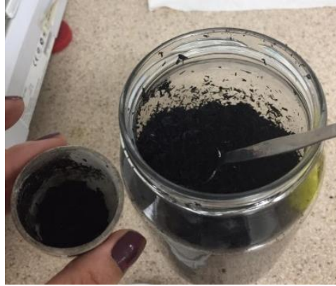
Resim 3.5 % 30'luk o-H 3 PO 4 ile aktifleştirilmiş kamış numunesi.
