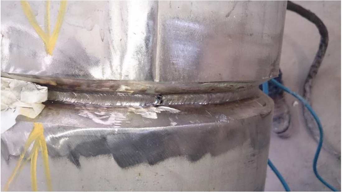
Resim 3.7 TIG Kaynak Yöntemi ile Yapılmış Kök Paso Görünümü.
