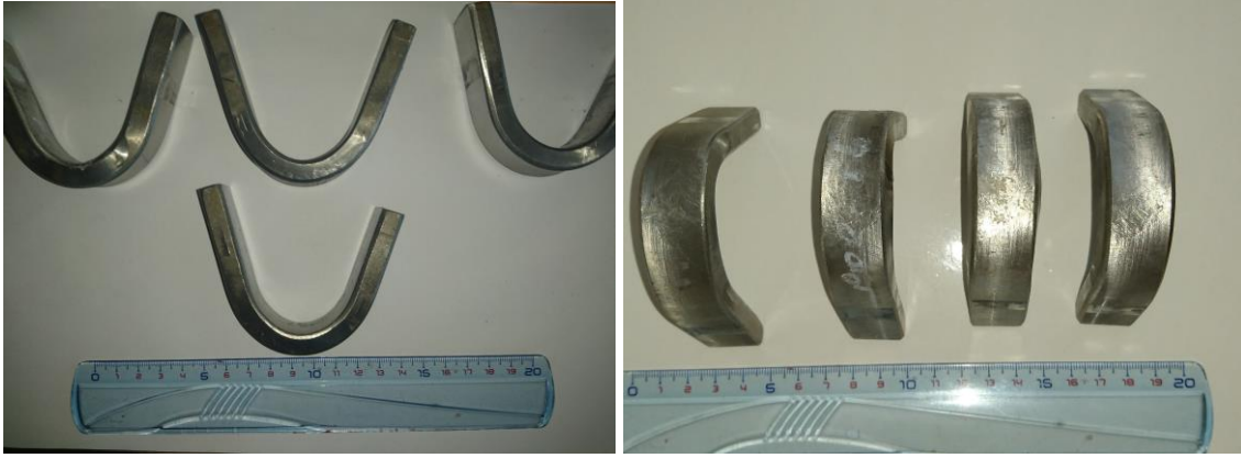
Resim 4.16 Eğme Testi Sonrası Numunelerin Görünümü.
