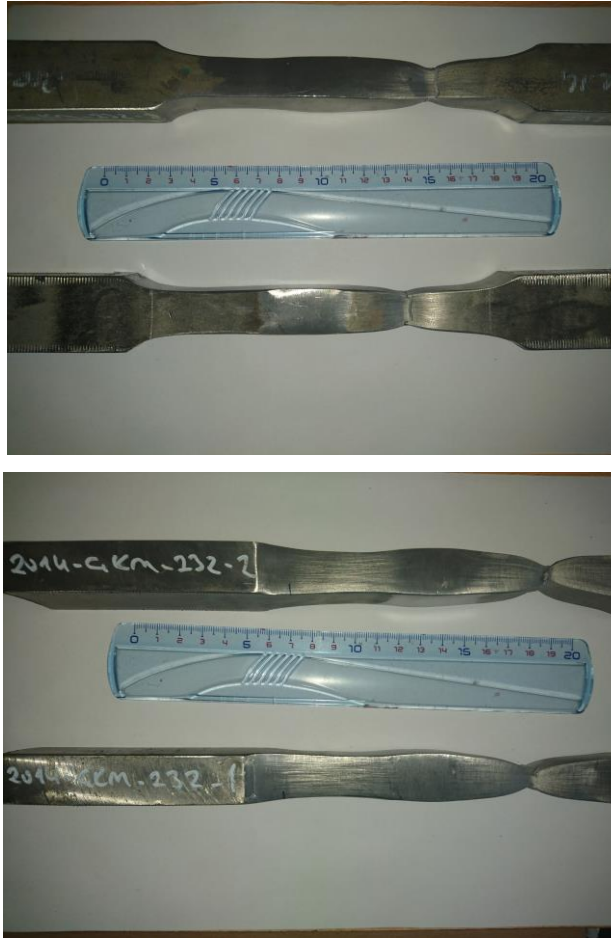
Resim 4.15 Çekme Testi Sonrası Numunelerin Görünümü.
