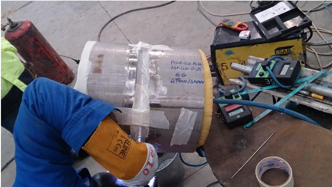
Resim 3.5 TIG Kaynak Yöntemi ile Birleştirme Yapılırken Dışarıdan Görüntüsü.
