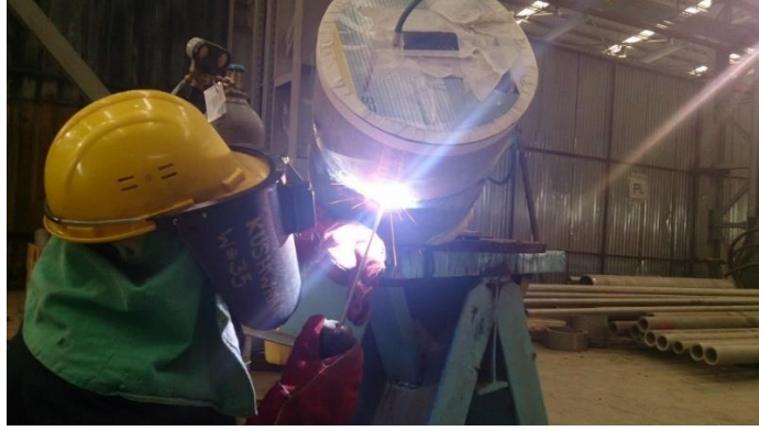
Resim 3.8 Örtülü Elektrod Ark Kaynak Yöntemi ile Devam Eden Birleştirme.
