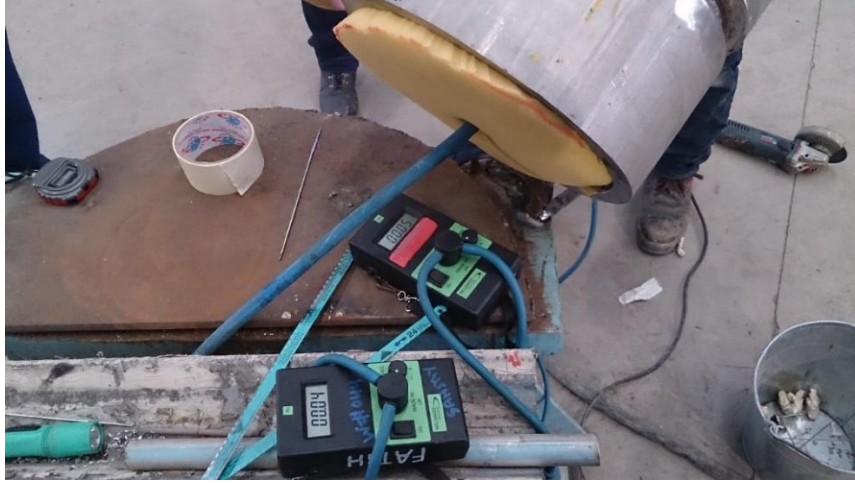
Resim 3.3 Hacimce % Oksijen İçeriği Tespiti İçin Kullanılan Düzenek.
