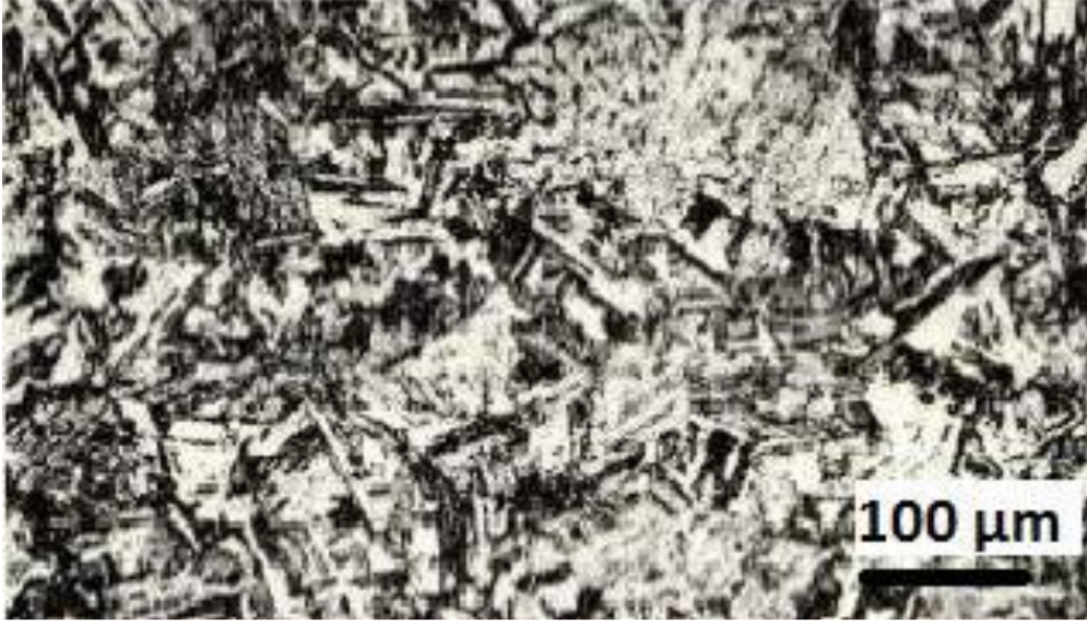
Resim 2.3 Çökeltme Yoluyla Sertleşebilen Paslanmaz Çeliğe Ait Optik Mikroskop Görüntüsü (İnt.Kyn.1).
