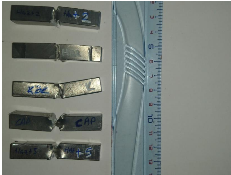
Resim 4.17 Charpy V-çentik Darbe Testi Sonrası Numuneler.
