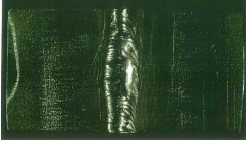
Resim 4.23 Korozyon Testi Sonrası Kök Paso Görüntüsü.
