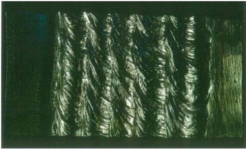
Resim 4.24 Korozyon Testi Sonrası Kapak(kep) Paso Görüntüsü.
