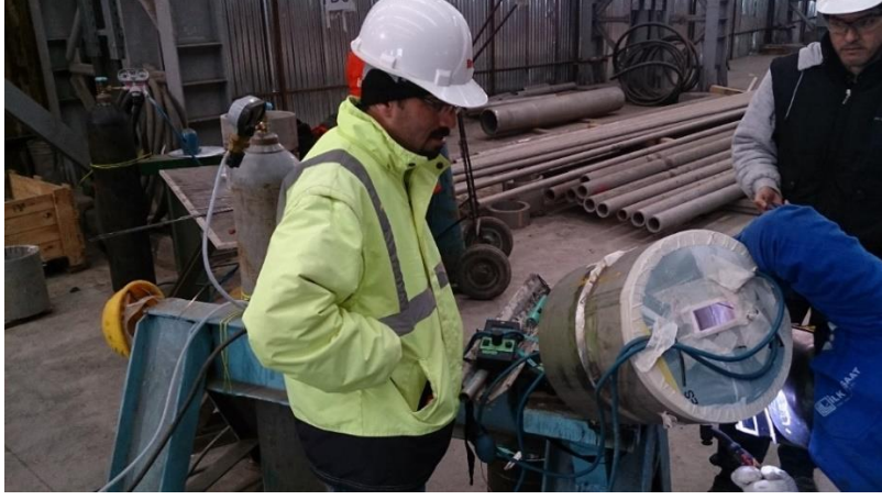
Resim 3.2 Kaynak Yapılacak Numunenin Konumlandırılması.
