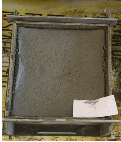
Resim 3.7 Genleşirme sonrası çökme gerçekleşmiş numune.
