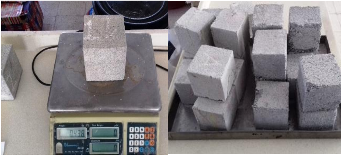
Resim 3.10 Etüv kuru numunelerin tartımı.
