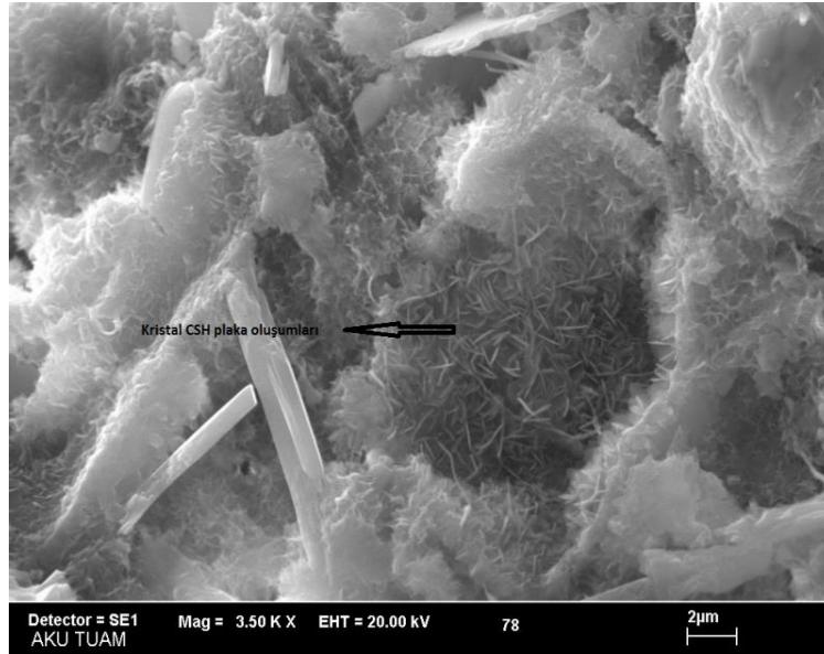
Resim 4.3 Numune içerisinde gözlemlenen kristal CSH plaka oluşumları.
