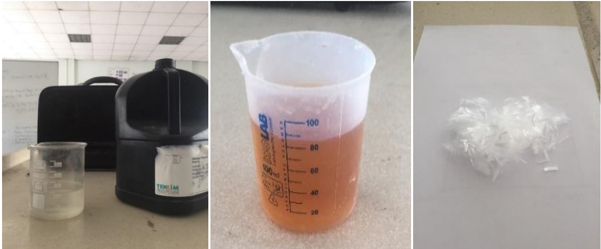
Resim 3.4 Çalışmada kullanılan hidrojen peroksit, süper akışkanlaştırıcı ve ploppropilen lif görüntüsü.
