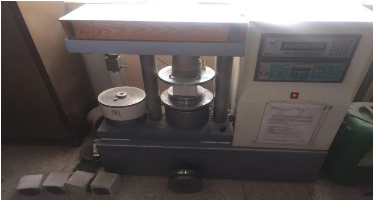
Resim 3.9 Numunelere uygulanan basınç mukavemeti deneyi.
