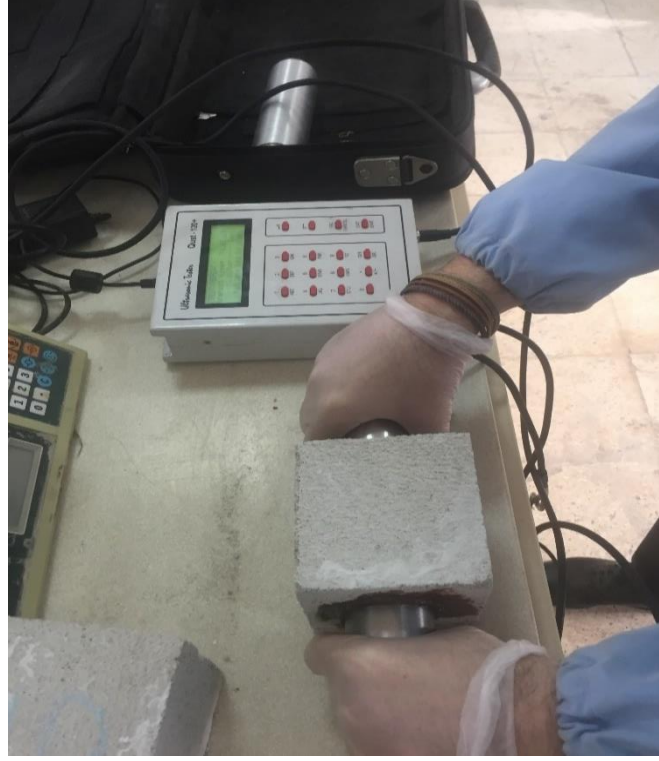
Resim 3.12 Numunelere uygulanan ultrases deneyi.
