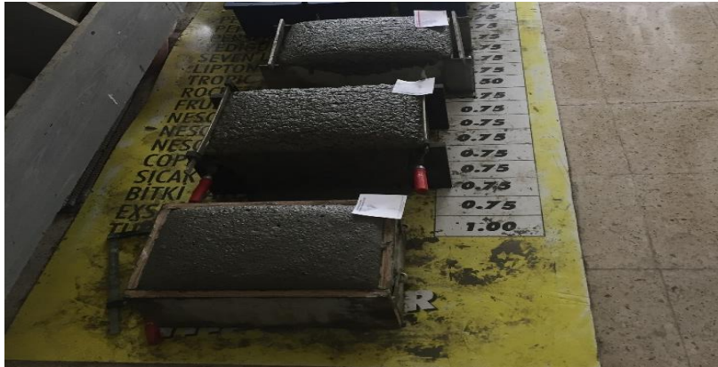
Resim 3.8 Genleşme gerçekleşmiş köpük beton numuneleri.
