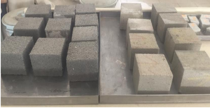
Resim 3.5 10x10x10 cm ebatlandırılmış köpük beton numuneleri.
