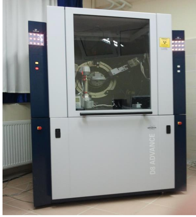
Resim 3.6 Bor tabakasındaki bor bileşikleri analizinde kullanılan XRD cihazı.
