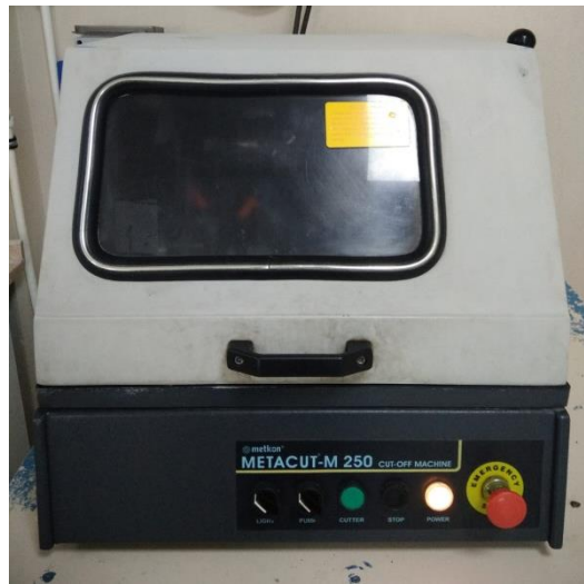
Resim 3.11 Hassas numune kesme cihazı.
