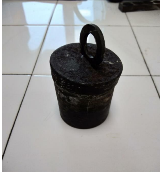
Resim 3.3 Borlama işleminde kullanılan paslanmaz çelik pota.
