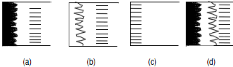
Şekil 2.10 a) tek fazlı FeB tabakası, b) tek fazlı Fe 2 B tabakası, c) geçiş bölgesi, d) çift fazlı FeB+Fe 2 B tabakası
