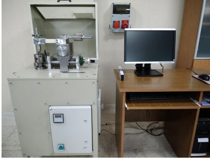
Resim 3.7 Aşınma deneyinde kullanılan aşınma cihazı.
