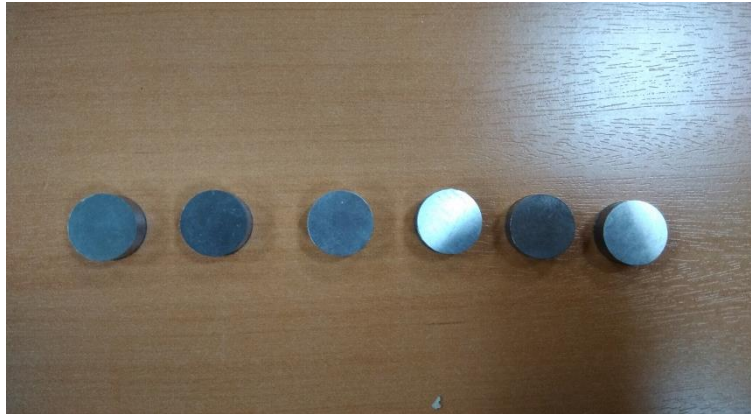
Resim 3.2 Yüzeyleri taşlanmış numuneler.
