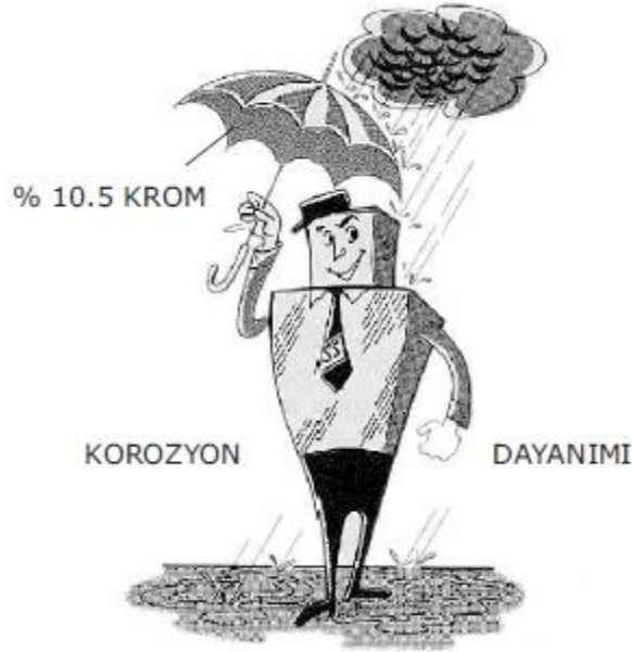
Şekil 2.1 Krom içeriğinin paslanmaz çelik içerisindeki görevi (Odabaş 2004).
