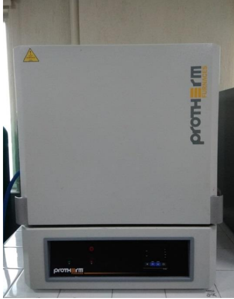
Resim 3.4 Borlama işleminde kullanılan fırın.
