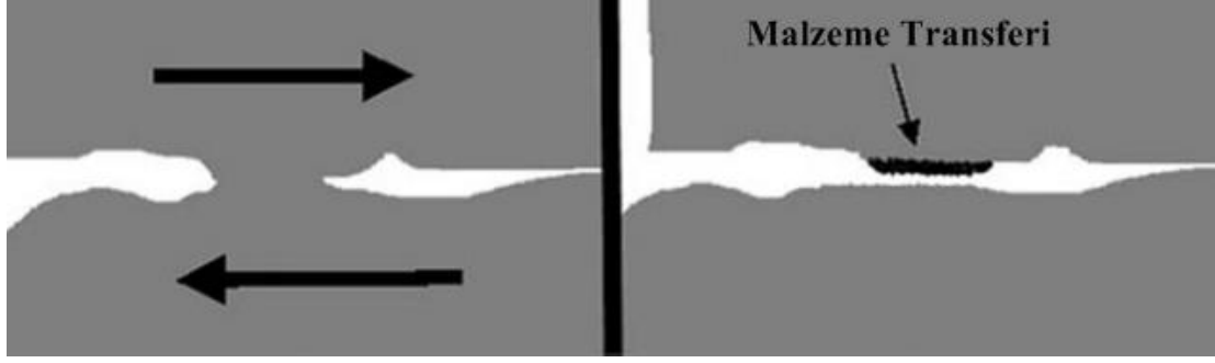
Şekil 2.12 Adhesiv aşınma oluşum mekanizması (Affatato and Brando 2013).
