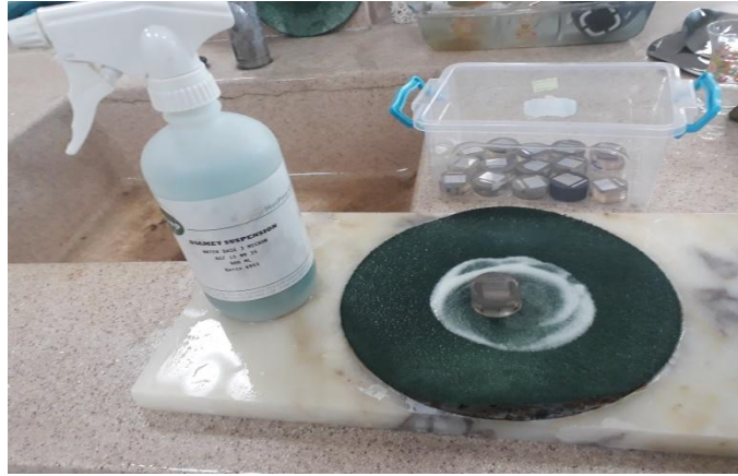
Resim 3.6 Parlatma sıvısı ile parlatma.
