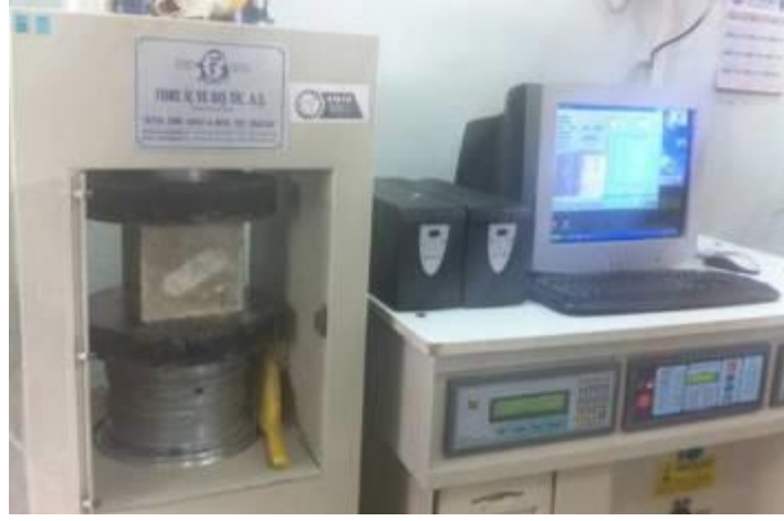
Resim 3.9 Basınç dayanımı deneyinin yapılışı.
