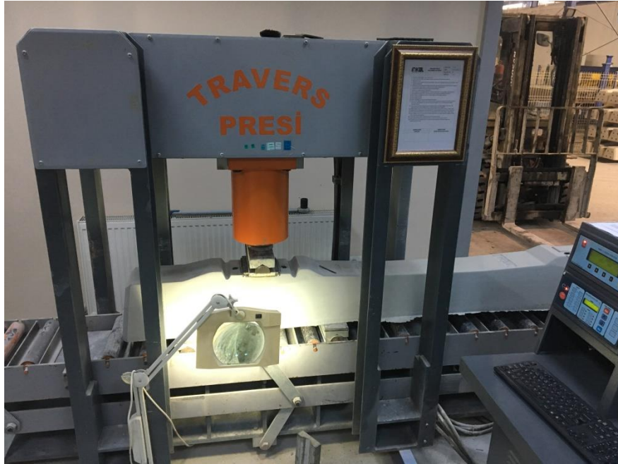
Resim 3.12 Beton traverslerin ray oturma bölümünde yapılan pozitif yük testi.
