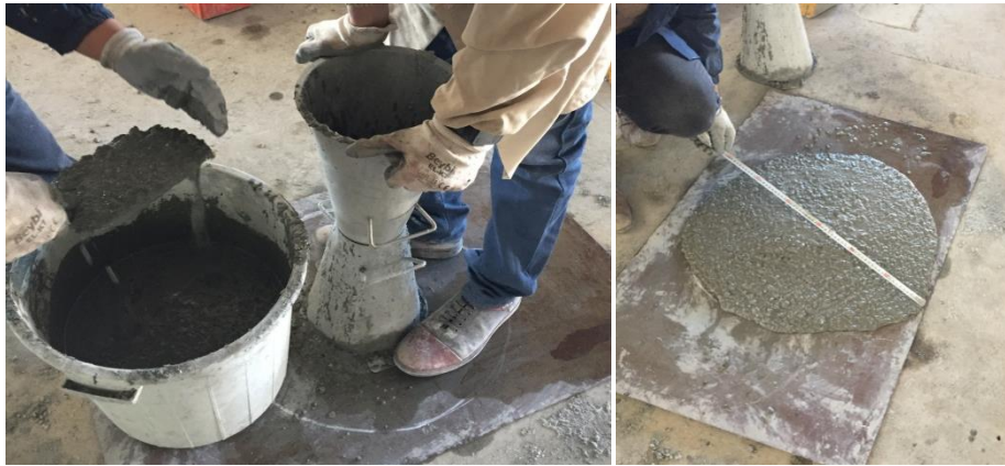
Resim 3.6 Yayılma ve t_{500} süresi ölçümü deneylerinin yapılışı.
