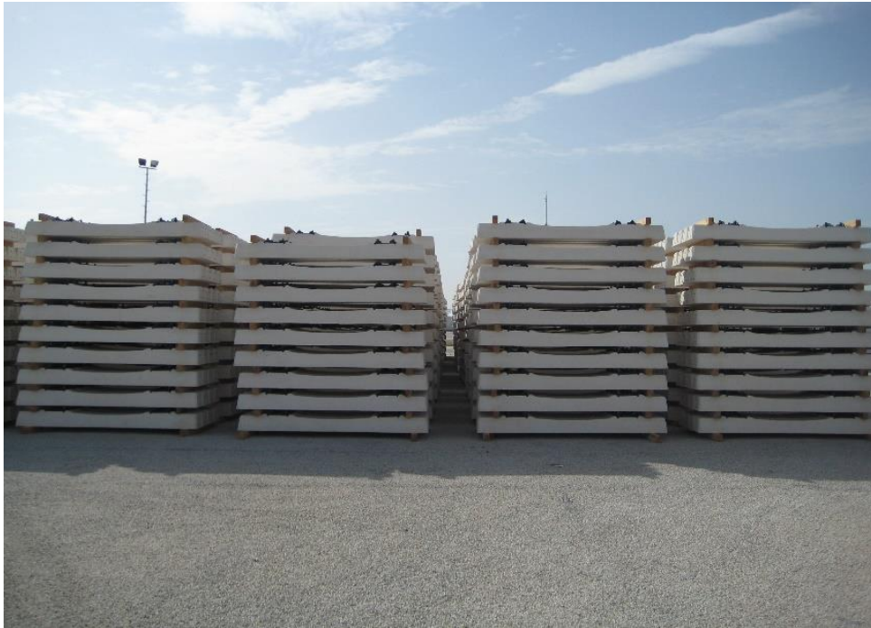
Resim 2.4 Öngermeli monoblok beton travers istif sahası ( İNKOL 2018 ).
