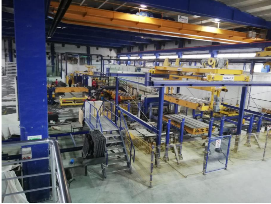
Resim 2.3 Karosel Sistem ile Öngermeli Beton Travers İmalatı (İNKOL 2018).
