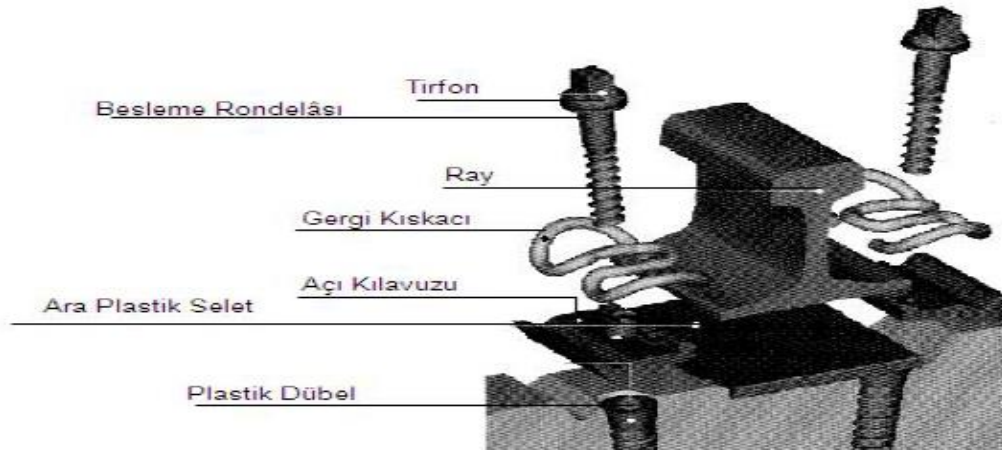
Resim 2.2 HM tipi ray bağlantı elemanları (TCDD 2018).
