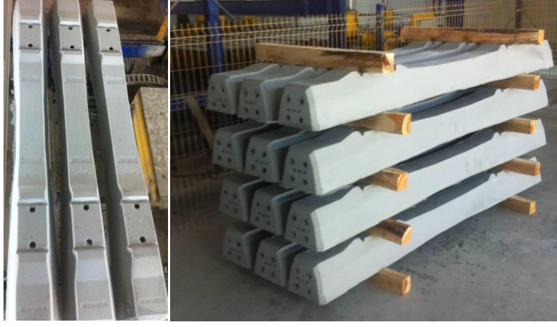
Resim 3.5 KYB kullanılarak üretilen beton travers numuneleri.
