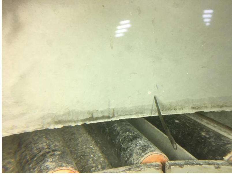
Resim 4.2 Beton traversin pozitif yük testinde 0,05 mm genişliğinde çatlak oluşumu.
