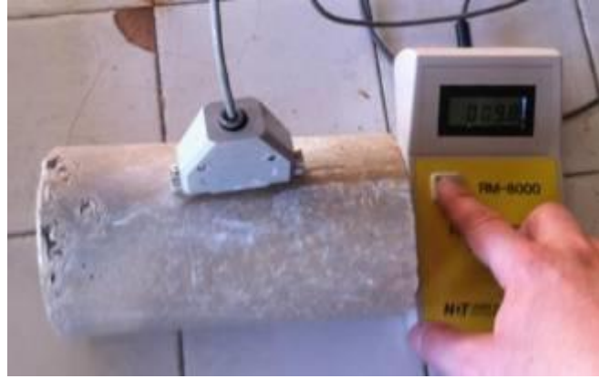
Resim 3.11 Elektriksel özdirenç ölçümü.
