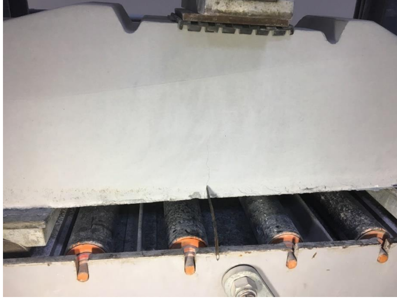
Resim 4.1 Beton traversin pozitif yük testinde 0,05 mm genişliğinde çatlak oluşumu.
