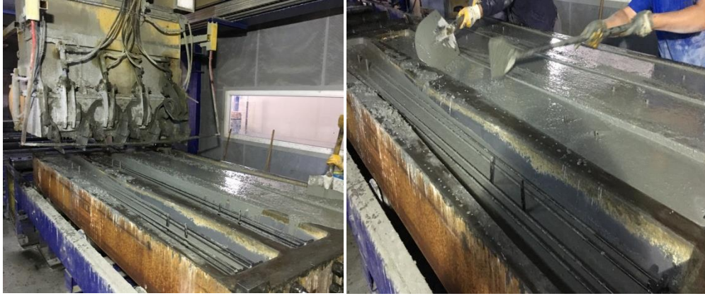
Resim 3.1 KYB travers numunelerinin üretimi.
