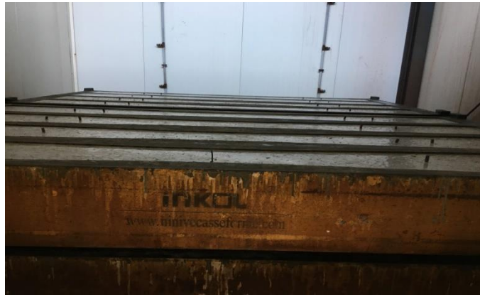
Resim 3.2 Üretilen KYB travers numunelerine buhar kuru uygulaması.
