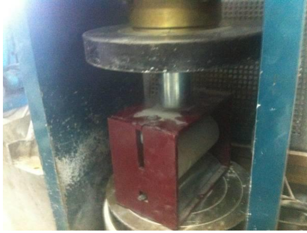
Resim 3.10 Yarmada-çekme dayanımı deneyinin yapılışı.
