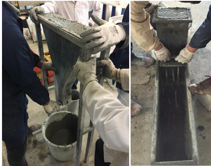
Resim 3.7 V hunisi ve L kutusu deneylerinin yapılışı.
