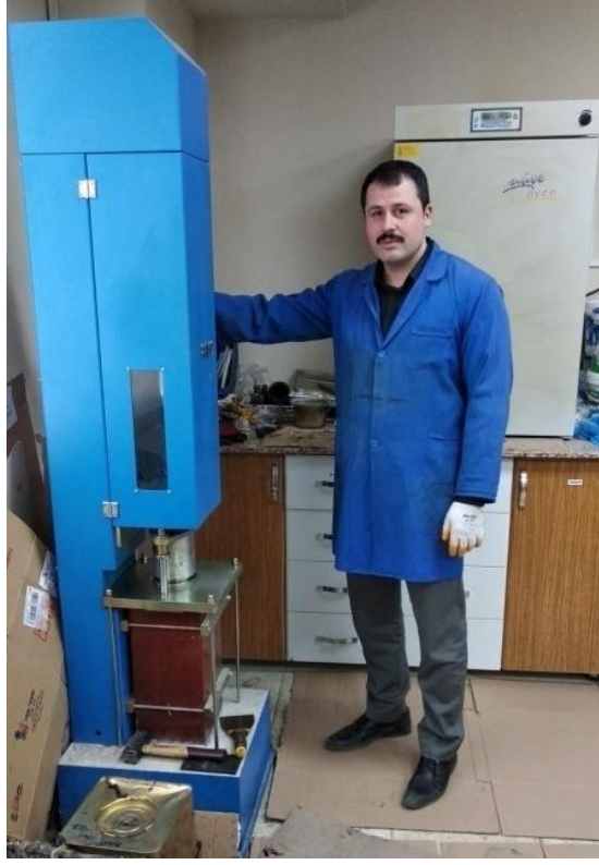
Resim 3.5 TMA numunelerinin Marshall Tokmađında sıkıştırılması.
