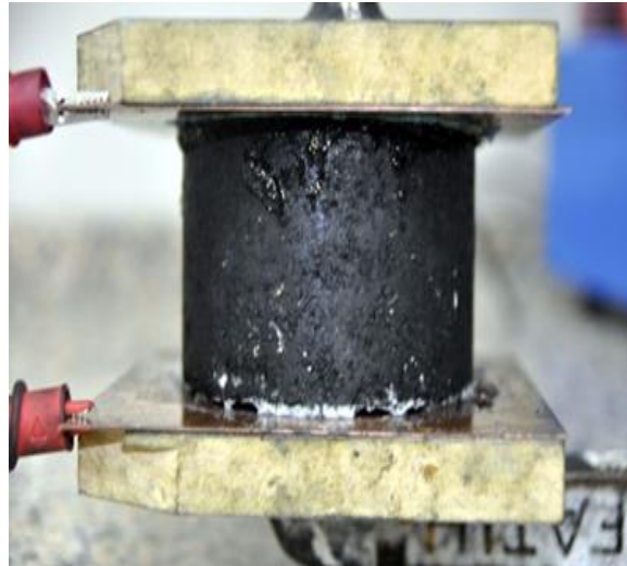
Resim 3.7 İki Elektrot yöntemi ile tekli numune özdirenç ölçümü.
