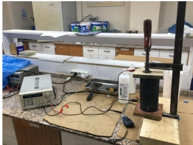
Resim 3.10 2'li Birleşim iletken asfalt numunelerinin elektrik akımı ile ısıtılması.
