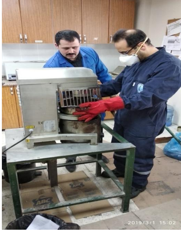
Resim 3.4 TMA karışımının ısıtıcılı mekanik mikser ile karıştırılması.
