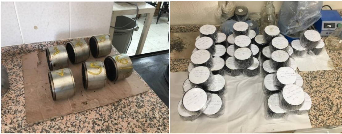
Resim 3.6 Üretilen TMA numuneleri.
