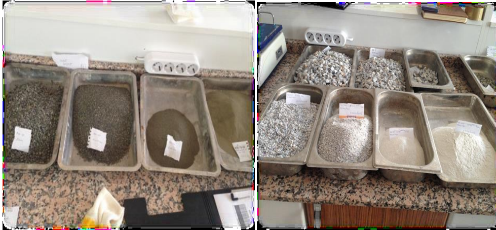
Resim 3.1 Asfalt karışımı için yıkanıp elenen bazalt ve kireçtaşı numuneleri.
