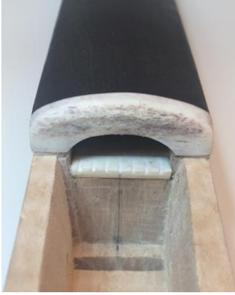
Őekil 144. Bař Eřik Yapıřtırılması
