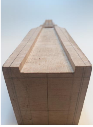
Őekil 133. Ahenk Telleri Kanal Derinliđi
