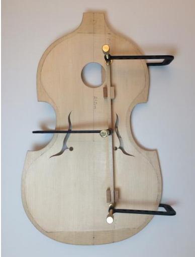
Şekil 95. Bas Balkon Yapıştırılması
