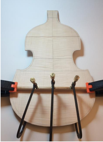
Şekil 49. Alt Balkon Yapıştırma
